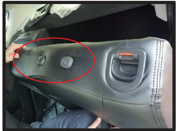
⑪1列目と同様にヘッドレストの台座を取り出します。
