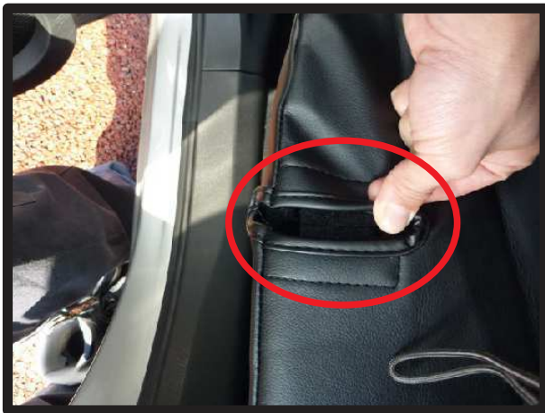
⑨カバー背面の加工穴をシートの穴位置に合わせてずれないようにマジックテープでシートに直接固定します。
