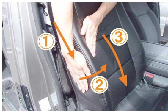
3 カバー側面の生地を、図の①～③の順番でシートに密着させるようにして、シワをなくしていきます。側面の生地がしっかりと張るまで繰り返し行って下さい。
