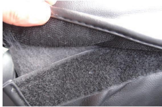
7 引き出した生地とカバー背面下のマジックテープを固定します。
