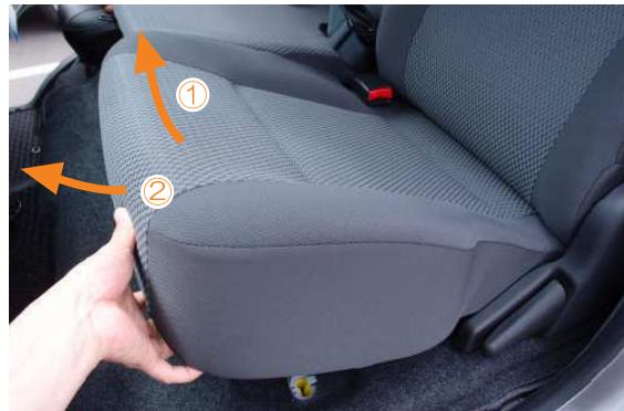
5 座面の前側を持ち上げてから、全体を前に引くと座面が外れます。
