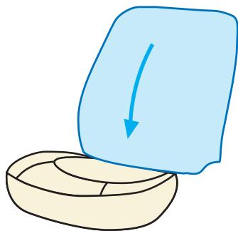
背もたれ部分のシートカバーを装着する前に、付属のビニールを被せます。この際、後で補助ビニールを引っ張り出しやすいように、カッターで両サイドに切り込みを入れておきます。
