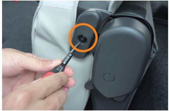
10 背もたれ付け根のプラスチックカバーのネジを外します。
