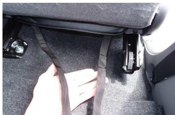
11 カバーの後ろ側に付いているベルトを座面の下を通し前方へ入れ込みます。ベルトを座面の下に通す際はシートを一番前にスライドさせ、座面の下に入れ込みます。
