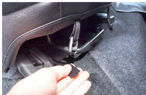
12 シートの前側からベルトを取り出す際はシートを一番後ろにスライドさせ引き出します。引き出したベルトとバックルはスライドレバーの上を通し固定します。
