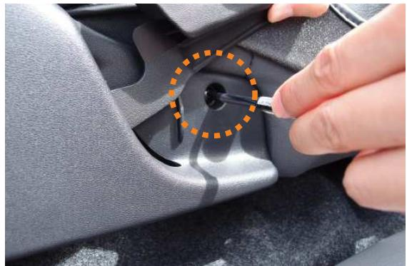
5 リクライニングレバーを上に持ち上げると図の丸印の位置にネジがあります。プラスドライバーを使用してネジを緩めます。カバー側面の生地をシートとプラスチック部の隙間に入れ込み、ネジを締めます。
