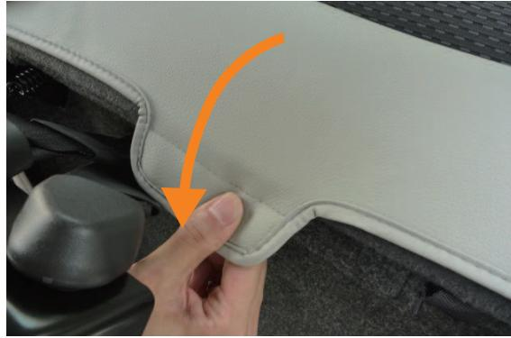
7 カバーの座面後ろ側面に付いているマジックテープを座面下に回り込むように持って行き、シート本体に直接貼り付けて固定します。
