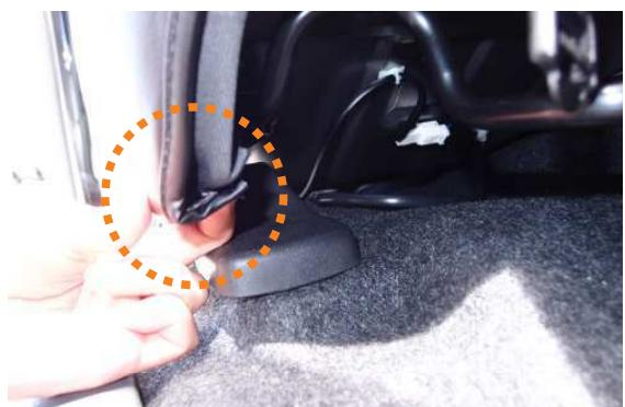
6 カバー外側面の生地裏に、大きなプラフックが付いています。プラフックは図のように生地と一緒に折り返してシートのフチにはめ込みます。
