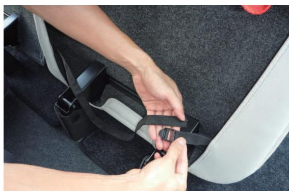
15 座面下の前方に付いているベルトをバックルに通し、1列目座面と同様に固定し、座面下の左右に付いているマジックテープをシート本体に直接貼り付けて固定します。
