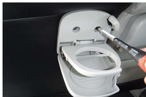
**17** ネジをもう一度取り外し、カップホルダーとバックグリップを元に戻します。
