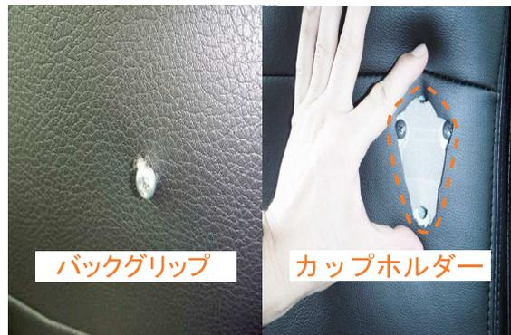
**16** 15番で付けた印の部分に切れ込みを入れネジを取り出す様に穴を開けます。カップホルダーは4つのネジを囲む様に穴を開けます。
