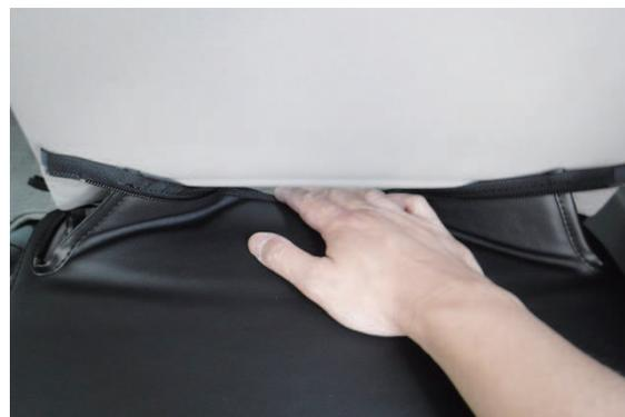
10 背もたれと座面の間隙間に生地を入れ込みます。
