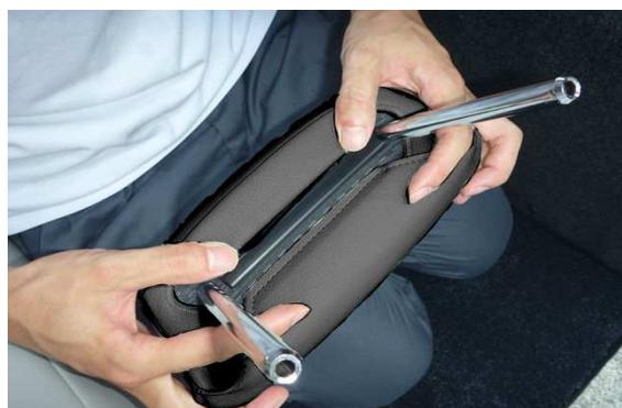
3 カバーを全体にかぶせたら、底面のプラフックを固定します。プラフックの固定方法は16Pの**プラフックの固定方法**をご覧ください。
