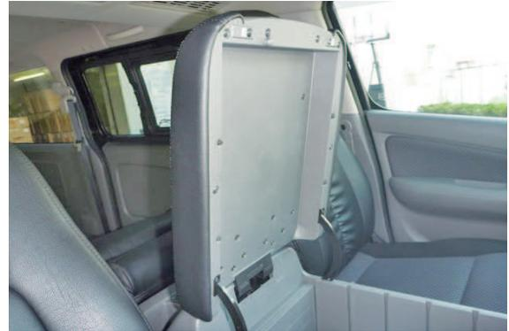
10 アームレストを元の位置に戻し、フタの裏側のネジを戻します。
