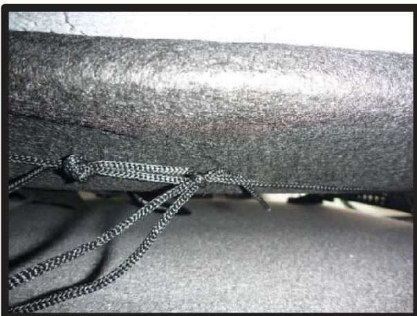
⑰ 2 ページ⑪と、⑭で後ろ側へ引き出したヒモ同士を固定します。 ※固定方法は巻末のヒモの結び方を参照して下さい。
