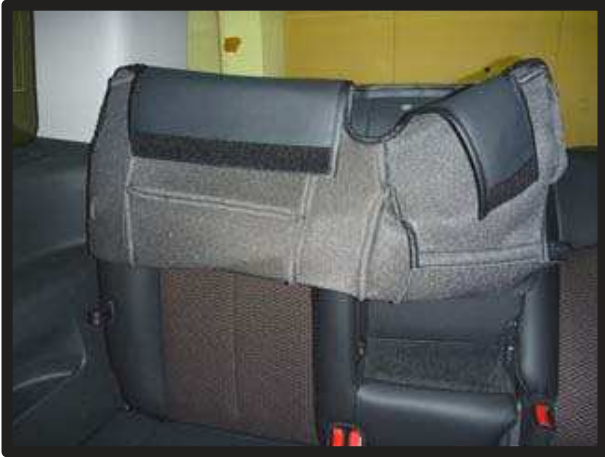
①カバーを図のように半分程裏返し、シートのラインに合わせます。
