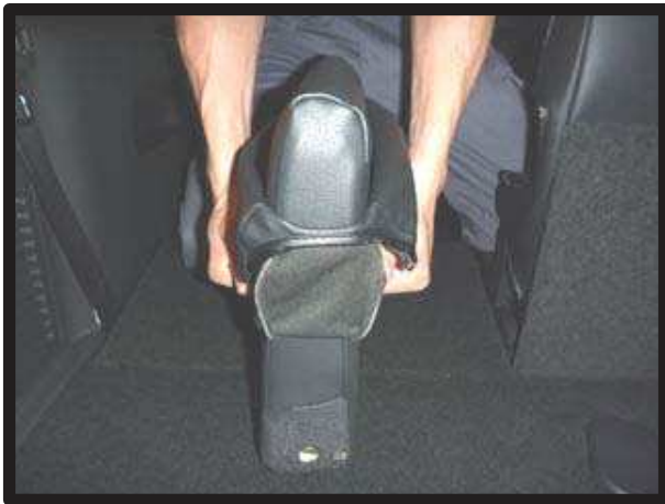
⑧ 14 ページで外したアームレストにカバーを半分程裏返し、ラインに合わせてカバーをかぶせます。
