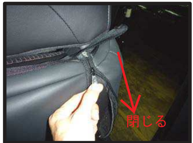
⑫ 生地を内へ寄せながら 9 ページの図④で開いたファスナーを閉じます。
