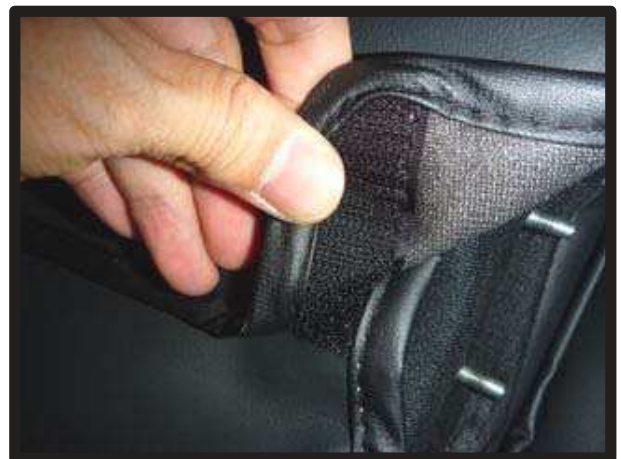
⑥アームレストの下パーツ部分はマジックテープで固定します。
