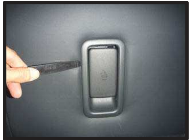
⑪ シート背面のシートスライド用レバー一部に、ヘラ等を使用し、生地を入れ込みます。
