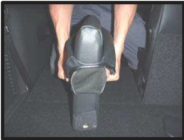
⑧ 18ページで外したアームレストにカバーを半分程裏返し、ラインに合わせてカバーをかぶせます。
