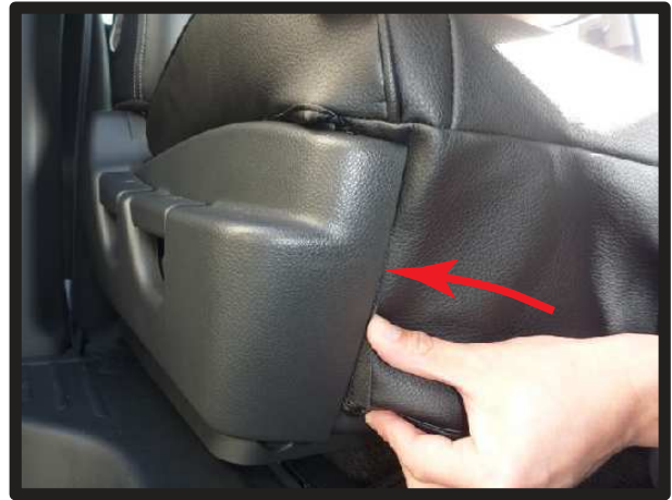
⑩シート側面のプラスチック部に、カバーに付いているプラスチックパーツを生地ごと入れ込みます。
