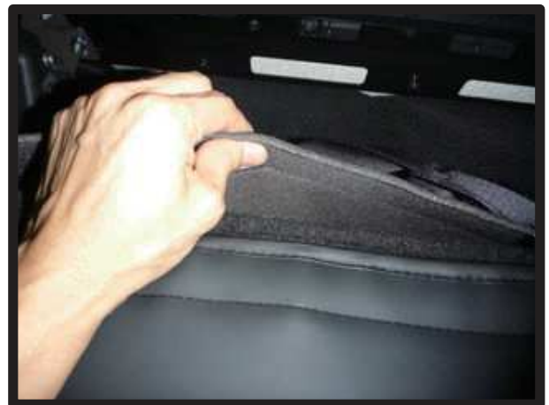
⑤カバーの背面下と図③で入れ込んだ生地をマジックテープで固定します。
