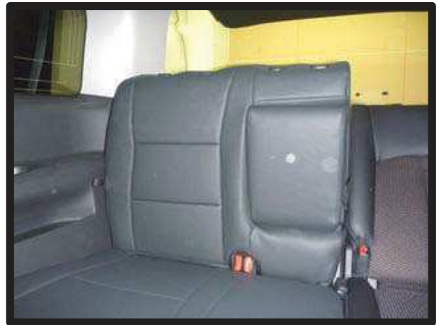
⑪ 14ページの逆手順でアームレストを戻し、カバーのラインを整え、3列目背もたれの完成です。助手席側は一部形状が異なりますが、同様に取付けます。
