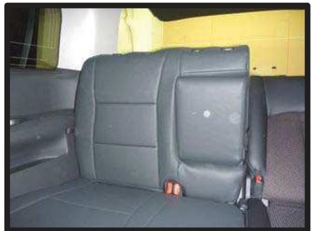
⑫14ページの逆手順でアームレストを戻し、カバーのラインを整え、3列目背もたれの完成です。助手席側は一部形状が異なりますが、同様に取付けます。
