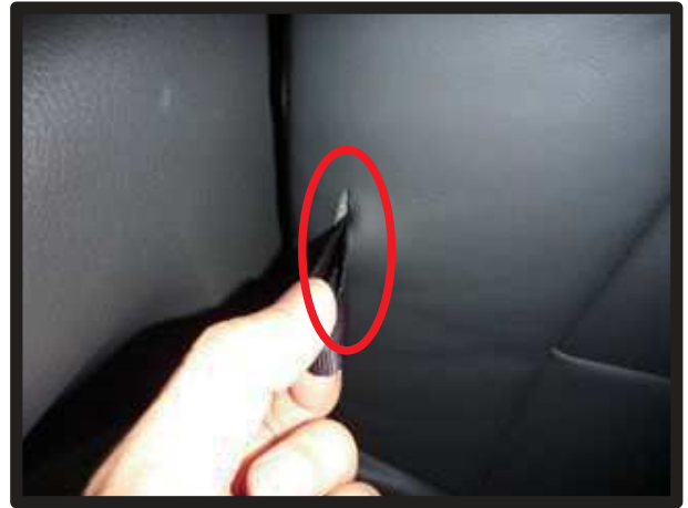
④背もたれ正面・背面の二ヶ所のカバーの加工穴からリクライニング用ストラップをそれぞれ取り出します。
