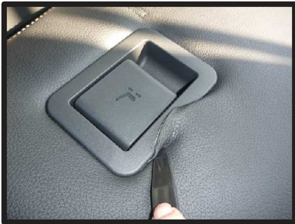
⑧シート背面のシートスライド用レバー一部に、ヘラ等を使用し、生地を入れ込みます。
