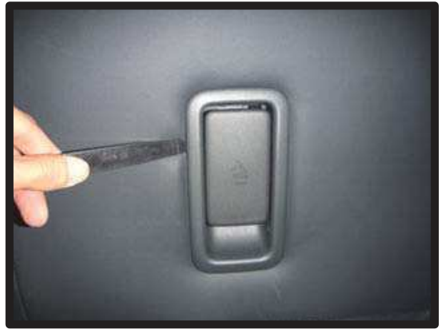
⑩シート背面のシートスライド用レバー部に、ヘラ等を使用し、生地を入れ込みます。
