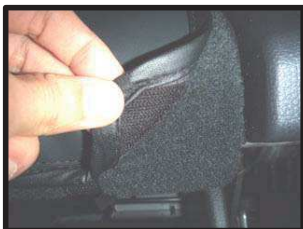
⑪6 ページの図②で入れ込んだ生地裏側に付いているマジックテープをシートに直接固定します。
