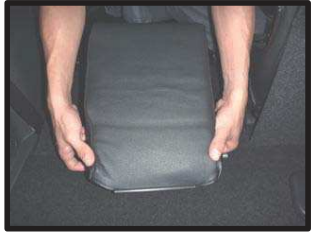
⑩ アームレストのラインからずれないようにカバーを全体にかぶせます。
