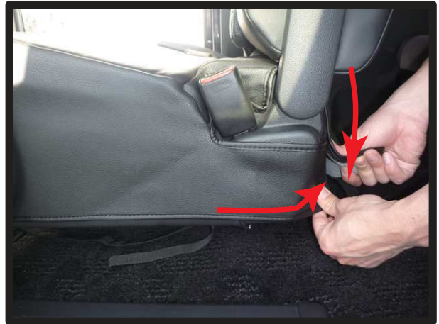
⑭カバー内側側面の生地を後ろ側へ引っ張り、図⑬で引き出した生地と、マジックテープで固定します。
