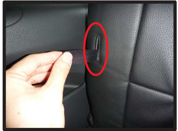
④カバーの加工穴からリクライニング用ストラップを取り出します。
