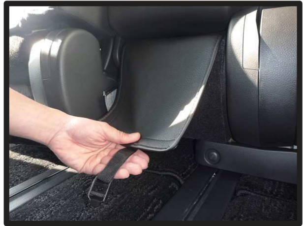
⑬ 8 ページの図③で入れ込んだアームレスト下の生地を後ろ側から引き出します。
