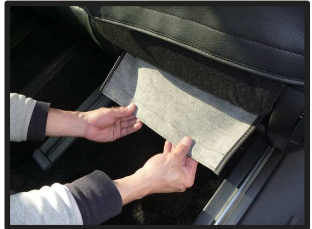
⑤入れ込んだ生地を後ろ側から引き出します。
