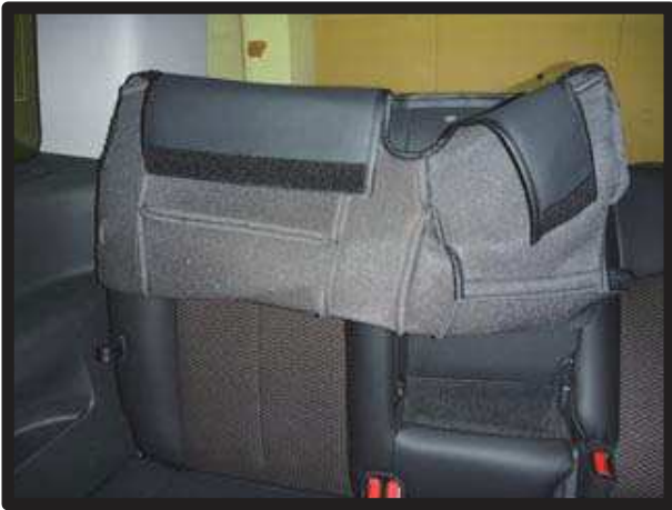
①カバーを図のように半分程裏返し、シートのラインに合わせてます。
