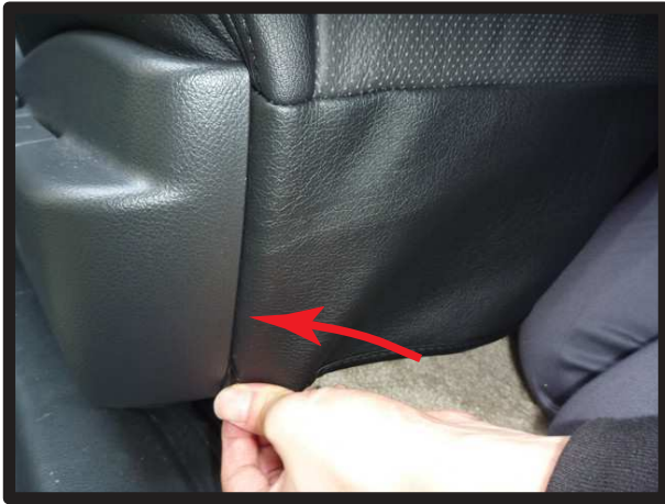
⑩シート側面のプラスチック部に、カバーを入れ込みます。
