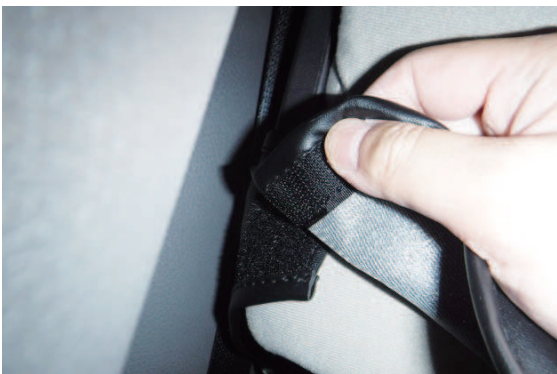
9 引き出した生地と4番の生地同士をマジックテープで固定します。
