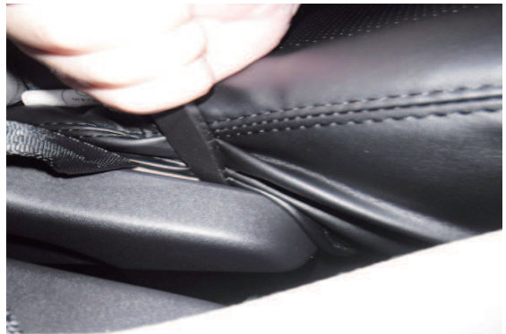
10 内側面の生地をプラスチックカバーの隙間に入れ込みます。
