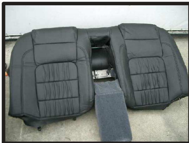
⑥シートのラインに合わせ、カバーをかぶせます。
