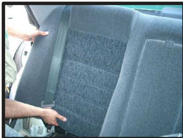
④シートを上にもずらすよう持ち上げ、取り外します。
