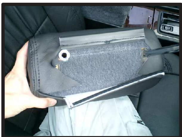
③裏面を向けて、プラスチックのフック同士で固定します。
