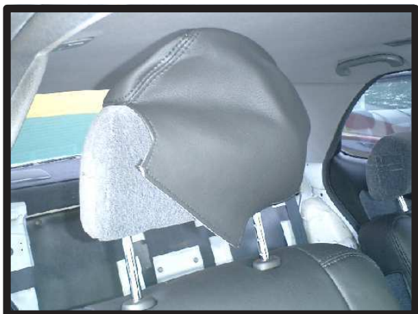
①ヘッドレストの片側から、カバーをかぶせていきます。
