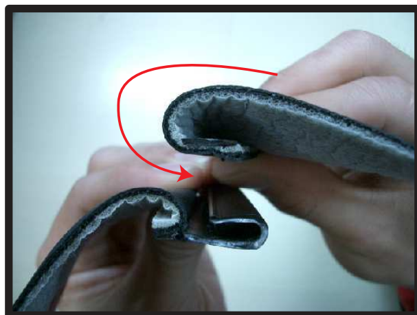
④平らなフックを、生地を巻き込む形でカギ状のフックへと入れ込んでいきます。
