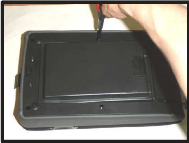
⑦枠をコンソールボックスに戻し、ネジで固定します。
