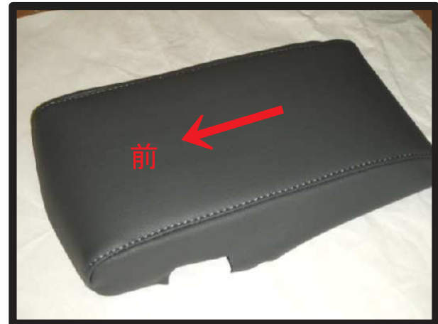
⑪カバーの前後を確認して上ブタにかぶせます。 内側に巻き込む生地は両面テープ等で固定します。
