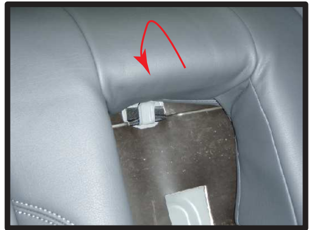
⑭ 背もたれを車体に戻します。外した時と逆の手順で取り付けます。⑥のフック3カ所に金属バーをかけます。
