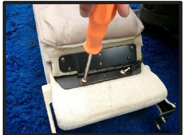
⑪-①アームレストを取り外し、さらにフタとボックス部分との2つに分けます。ネジは、+ドライバーで取外せます。
