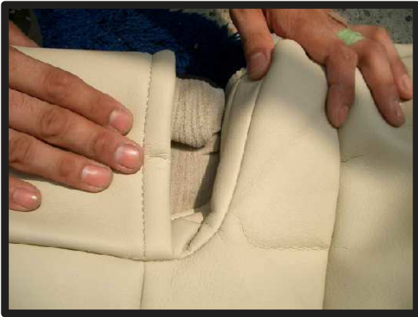
④シートベルトの差込口周りです。 カバーを隙間に折り込みます。
