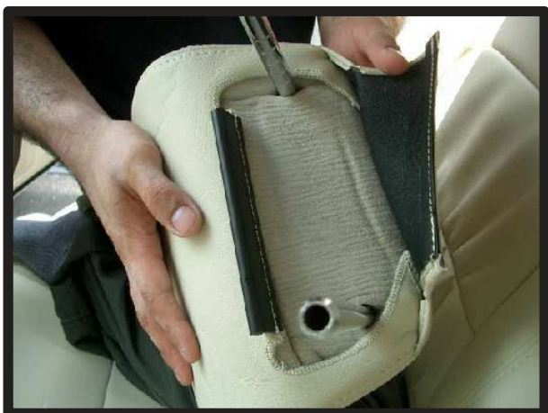
③ヘッドレストを裏返して、カバーのプラフック同士で固定します。
