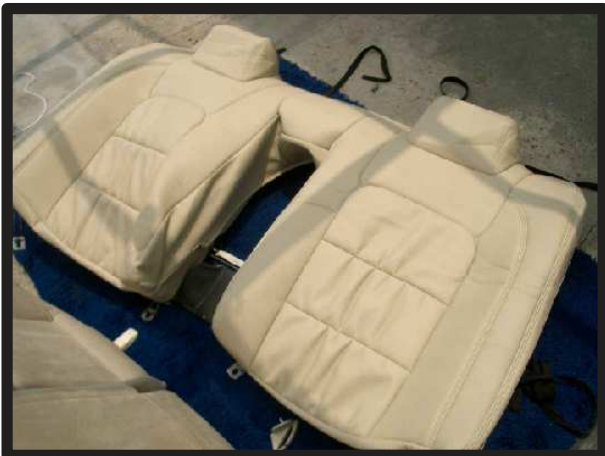
⑧背もたれカバーをシートのラインに合わせてかぶせます。
