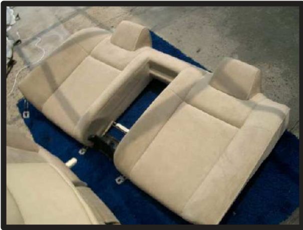
⑦アームレスト部を取り外すと、背もたれは、このようになります。
