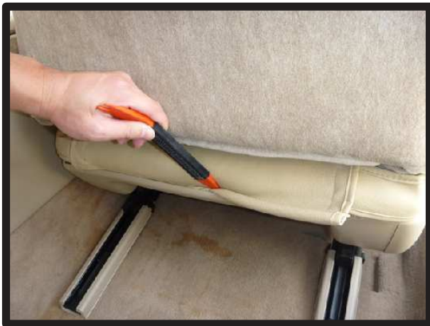
⑨プラスチックカバーの間に生地を入れ込みます。
