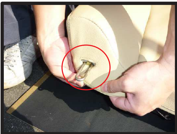
⑫背もたれ下部の金具を、カバーの加工穴から取り出します。
