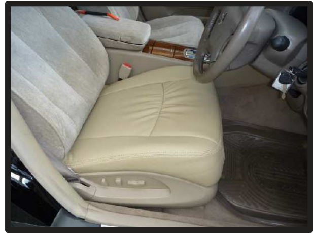
⑪カバーのラインを整え、運転席座面の完成です。 助手席側も同様に取り付けます。
