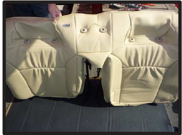
⑬1列目と同様に、ヘッドレストの台座を取り出します。
