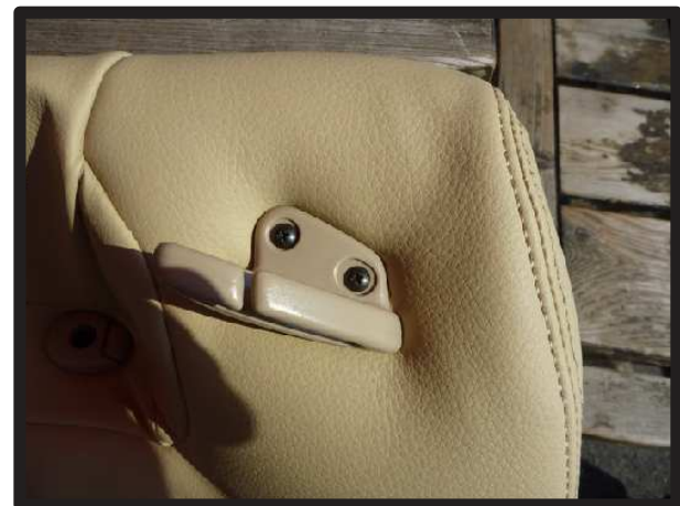
⑮⑦で外したシートベルトのガイドを元に戻します。(計3ヶ所)
