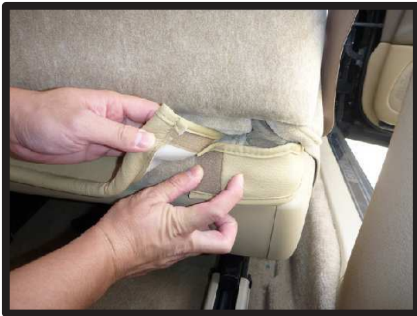
⑧④で後ろ側へ回した生地と、⑤で引き出した生地をマジックテープで固定します。
