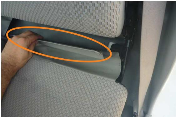
2 背もたれを倒し、写真○部のパートを背もたれと分離させます。
