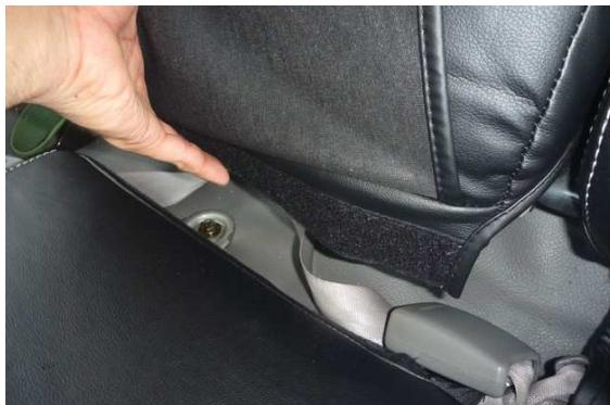
2 シートのラインに合わせてカバーをかぶせていきます。カバーは、中央席下部でマジックテープで固定します。
