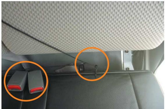
5 カバーに付いているゴムに、シートベルトの受け口を通し、左右のヒモをシート奥で結び固定します。
