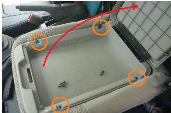
1 カバー取り付け前に、中央席を倒しフタを開け、○部のネジをプラスドライバーで外し、トレーを取り外します。
