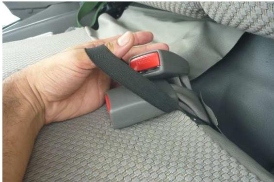
1 カバーを取り付ける前に、シートベルトの受け口をゴムから抜き取ります。
