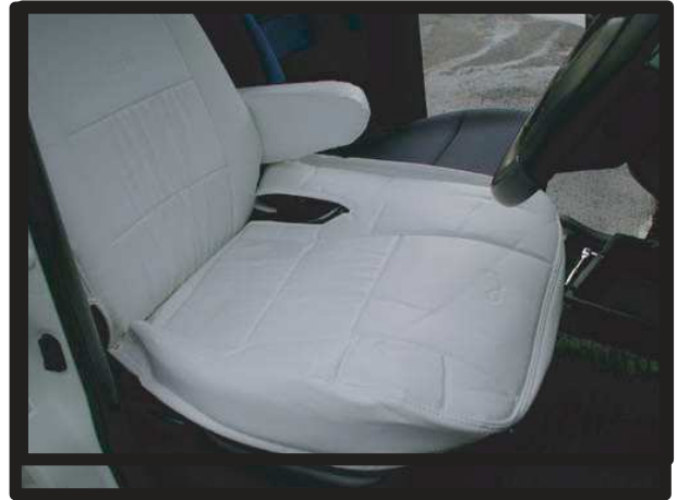
⑩純正のシートのラインに合わせて、座面にシートカバーをかぶせます。ラインがずれるとたるみの原因になります。
