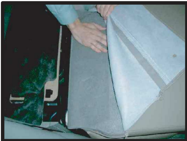
⑨⑥で外したカーペットをシートカバーの中に入れ込みます。
