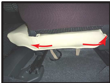
⑭座面の背面は写真のようになります。シート背面の生地は内側に生地が寄らないように、外側へ引っ張るようにして伸ばします。生地の手はプラスチック部のフチへ入れ込みます。
