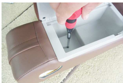
15 ボックスを元に戻します。 ボックスの裏にツメが付いているので向き を確認しながら戻して下さい。
