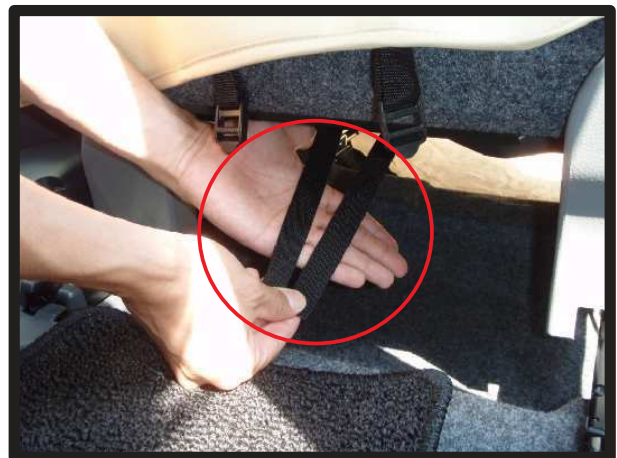
⑪カバー前部にあるベルト（2本）を座面下のスライドレバーの上を通して背面に引き出します。座面カバー後部のベルトと固定します。
