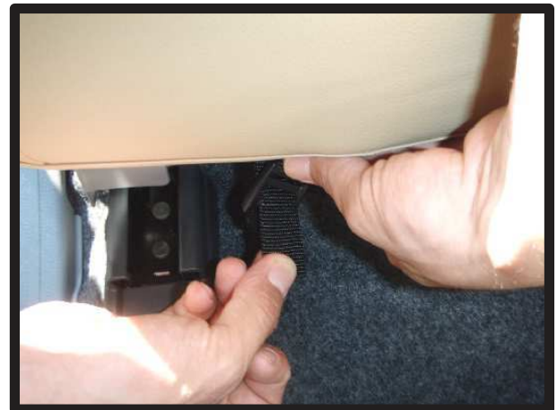
⑥カバーの前後に付いているベルトを座面前側で固定します。
