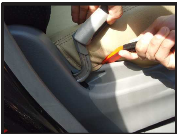
⑨リクライニングレバー部分の生地をヘラ等を使用して、シート本体とプラスチックカバーの間に入れ込みます。
