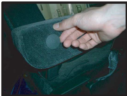
①アームレストのプラスチックカバーを外します。
