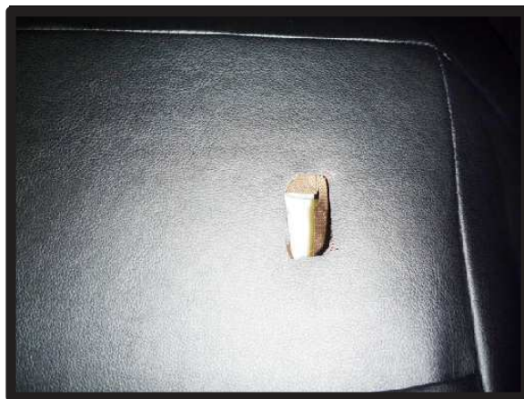
⑤付けた印部分を図のように切り抜きます。生地を切り抜く際に、シートを傷付けないようにご注意ください。
