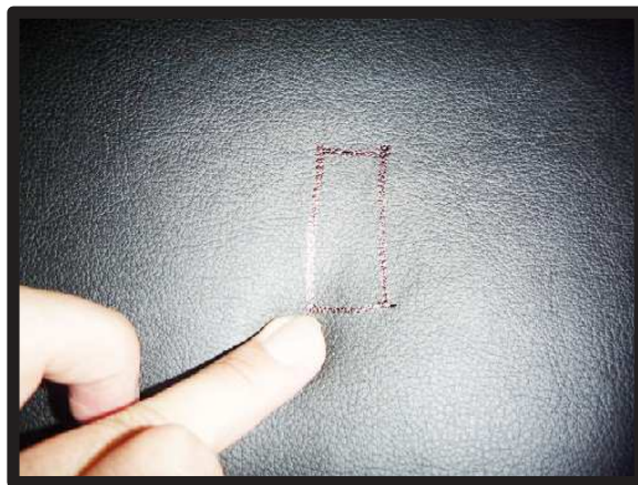
④カバーを装着後、コンビニフックの穴位置を確認して、穴のフチに沿って印を付けます。
