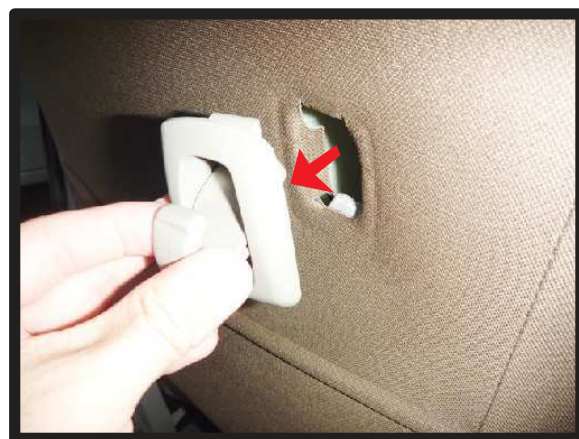
③ツメを起こしながらフックを手前に引くとシートからコンビニフックが外れます。
