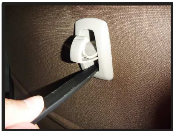
①フックを出した状態でヘラなどを使用して中にあるツメを起こします。
