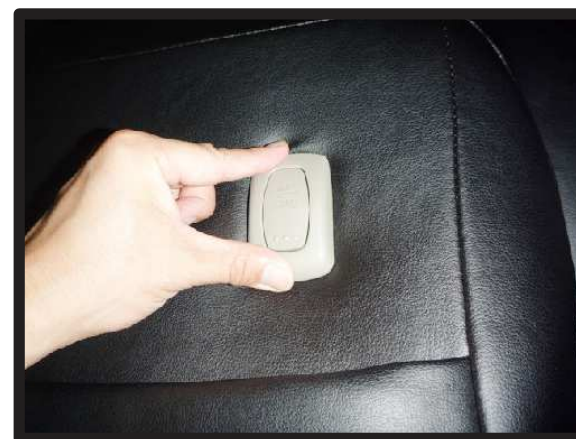
⑥穴開け加工した部分にコンビニフックを押し込み元に戻します。最後にフックを軽く引っ張り、確実に固定されているか確認して下さい。
