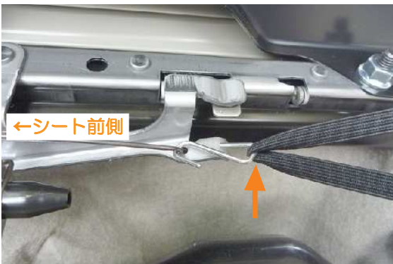
18 S字フックは図の針金のような部分に引っかけて固定します。助手席側はシートを前に倒すと、このゴム部分が引っ張られゴムが切れてしまう恐れがありますので、S字フックは指定の位置に固定するようにして下さい。
