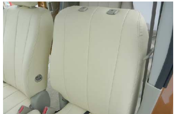
20 カバーのラインを整えて、1列目助手席側背もたれの完成です。
