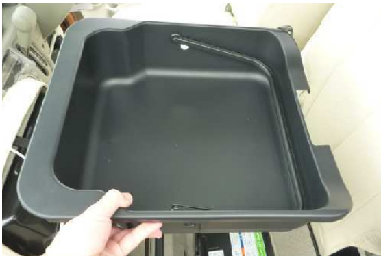
17 助手席側背もたれカバーも固定方法は運転席側と同様に取り付けますが、カバー背面下のゴムの固定位置が運転席側とは異なります。座面シートを跳ね上げて、シートアンダーボックスを外します。
