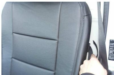
8 上下左右に取り付けてあるマジックテープの長い方を、背もたれ裏の隙間に手を突っ込みながら反対方向に取り付けてある短い方のマジックテープ側まで入れ込みます。
