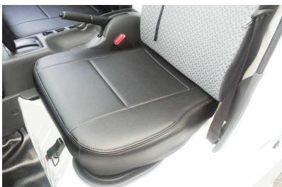
9 カバー両側面の生地もシートと車体の隙間に入れ込むようにします。
