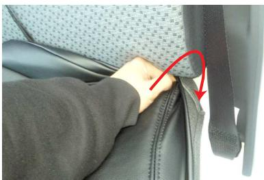
8 座面後部を包み込むようにカバーをかぶせます。
