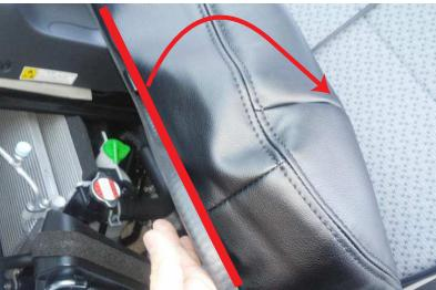
7 カバー前面をシートと車体の隙間に引っ掛け、シートのラインに合わせてかぶせていきます。
