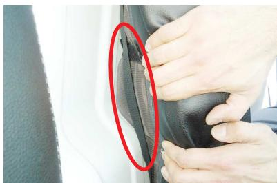
9 背もたれと車両の隙間で、マジックテープ同士を固定します。
