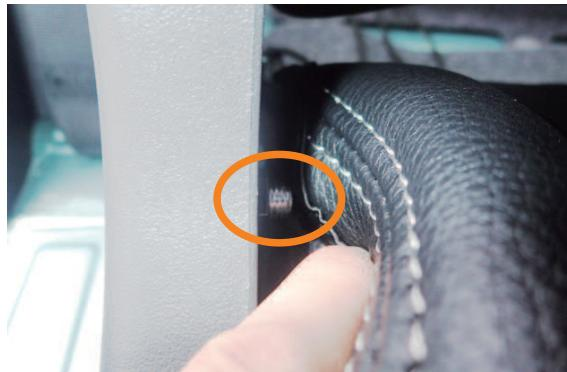
4 ヒモは、図の○部分のボルトの下側を通すようにして下さい。
