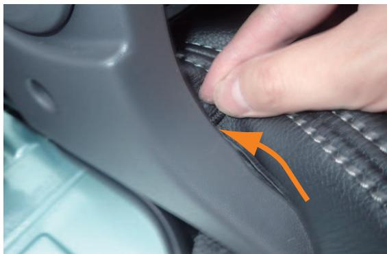
3 カバーの外側面に付いているヒモを、シートの側面に沿わせるようにしながら、後ろ側へ通します。
