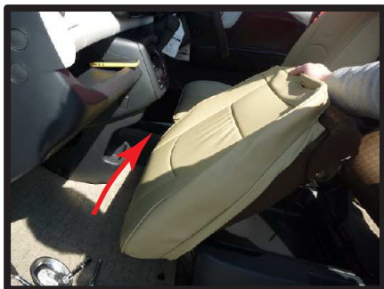
①シートを跳ね上げ、前側からカバーをかぶせます。
