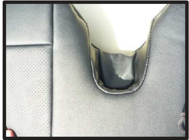
⑩シートの表を向けてシートベルト収納部分の形を整えます。 ※年式が平成22年9月以降の車のみ。
