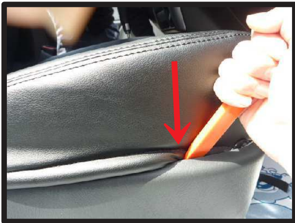
⑦カバー外側面の生地をヘラ等を使用してシートと台座の隙間へ入れ込みます。
