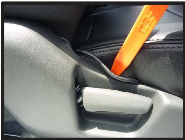
⑧リクライニングレバー周りの生地をシートと台座の隙間へ入れ込みます。
