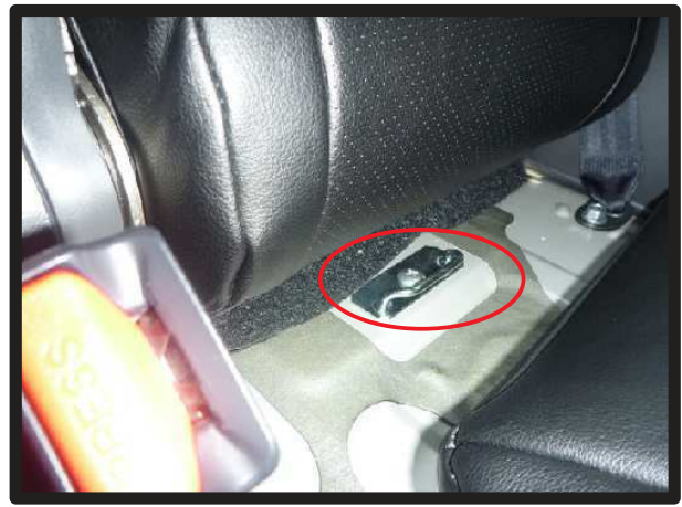
⑫2列目座面を車体に戻すときは図の○位置の金属部に5ページ⑤の○で示した金属部分を引っ掛けるように戻します。
