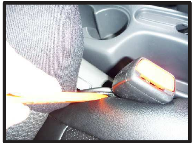
⑩シートベルトバックル周りの生地をシートと台座の隙間へ入れ込みます。
