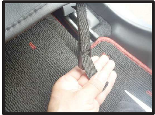
⑩ベルトをシート背面から引き出します。引き出したベルトを1ページ②で入れ込んだ生地に付いているバックルに通します。
