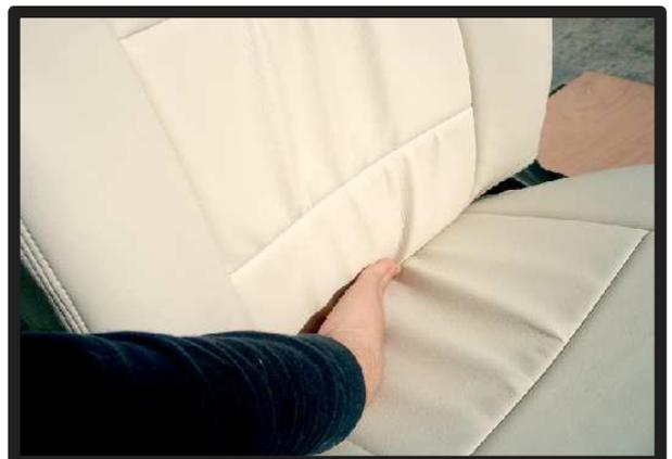
⑤背もたれの曲線にたるみなくカバーを密着させながらマジックテープ部を背面と座面の間に入れ込みます。
