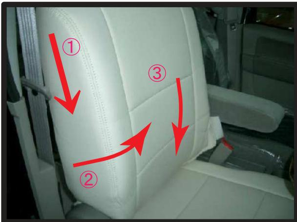
③①～③の順番にカバーをなで下ろしてシートに密着させるようにしわをなくしていきます。
