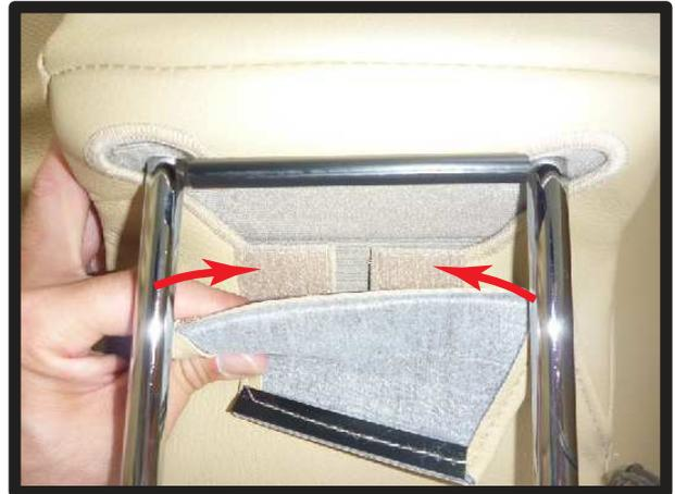
⑧ヘッドレスト裏で生地を内へ寄せなら、マジックテープで固定し、1列目同様にプラスチック部品を固定します。
