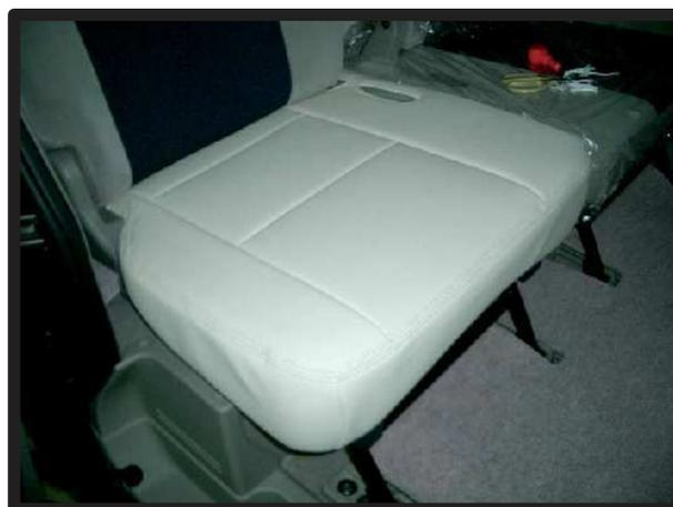
⑤後ろ側のマジックテープを固定します。シートベルトバックルが出ている隙間に生地を入れ込みます。シートを起こしてスライドさせてから再度シートを固定する作業を行って下さい。
