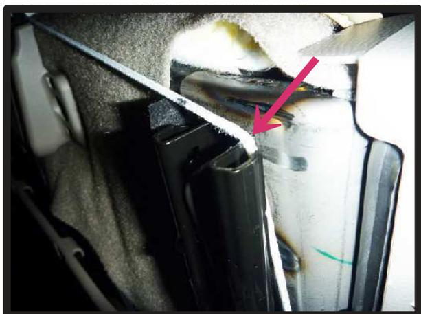
③紐を図のように通します。シートを後ろへ引いた上体で跳ね上げ、シートレールの図の付け根に、ヒモを引っかけるようにして通します。
