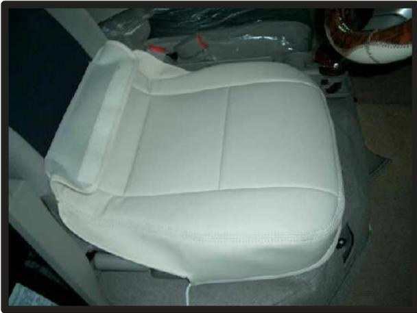
①運転席の座面カバーをシートのラインに合わせてかぶせます。
