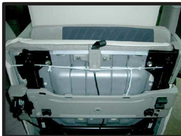
④両側から通した紐を1列目と同様に結びます。カバー前側のゴムは付属の金属フックを使い、シートスライド用レバーを避けて座面下へ固定して下さい。
