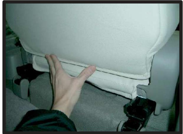
⑤裏側に引き出したマジックテープ部分を固定します。アームレスト下部のマジックテープも固定します。
