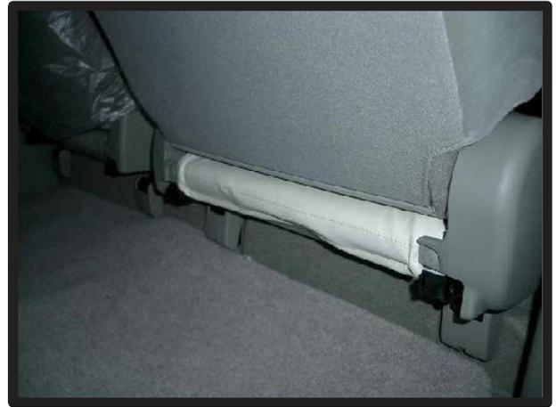
④③で固定した紐をカバーの中に入れ込み、マジックテープをシートに固定します。
