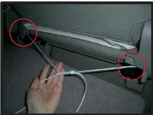
③左右から出ている紐を○印の部分に通るように後ろへ引き出します。片側の紐で輪を作り、反対側の紐を通して絞り込んでから結びます。
