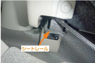
**7** カバー内側面から出ているヒモも、シート側面裏を通してシートの背面へ引き出します。ヒモはシートレールの上を通るようにして下さい。
