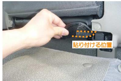
**11** 5ページ3番で引き出した生地を、シートに直接マジックテープで貼り付けて固定します。
