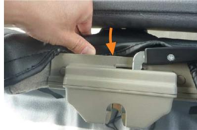
**10** シート中央の後ろ側です。シートとプラスチック部の隙間に生地を入れ込みます。
