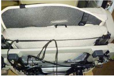
9 座面をはね上げ、8番で背面へ出したヒモを1列目座面と同様にシートレールの上に引っかけて固定します。固定方法に関しては22ページをご覧下さい。
