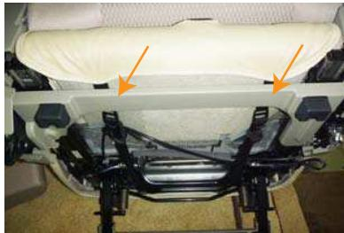
10 カバー前面に付いているベルトをスライドレバーと矢印部分の上を通し、12ページの4番で引き出した生地に付いているベルトと固定します。
