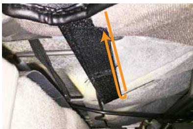
8 カバー外側面に付いているマジックテープを座面裏の金属バーに巻き付けるように固定します。
