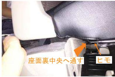
10 カバー両側面から出ているヒモを座面裏中央部分へ通します。
