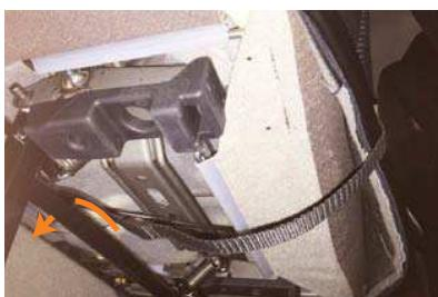
9 カバー前側に付いている2本のベルトを座面裏の金属バーの上を通し、14ページの4番で引き出した生地に付いているバックルに固定します。
