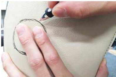
9 アームレスト装備車の場合は、内側側面のアームレストが付く位置を手で探し、ボールペン等で印を付けます。
