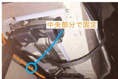
11 10番で中央へ通したヒモを中央部分（図で記している箇所）で固定します。
