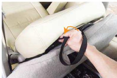
14 カバー前面に付いている2本のベルトをスライドレバーの上を通して、上から下に垂らすようにして入れ込み、シート背面から引き出します。
