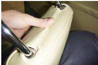
3 ラインを整え、ヘッドレストをシートから外します。ヘッドレストの裏で、カバー前後に付いているプラスチックフックを固定します。
