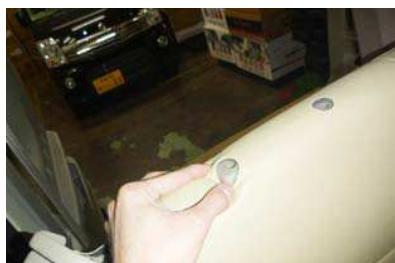
5 カバーの加工穴からヘッドレストの台座を取り出します。
