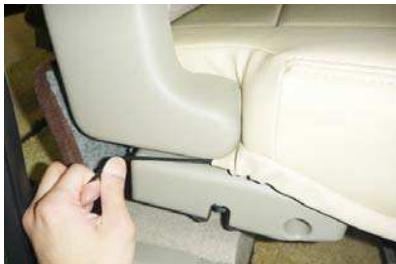
8 カバー外側面のヒモをプラスチックカバーの下を通して、背面へ出します。内側面も同様にプラスチックカバーの下を通してします。
