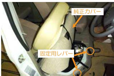
7 シート下の台座前面にある純正のカバーをめくり上げ、シート固定用のレバーを外し座面をはね上げます。
