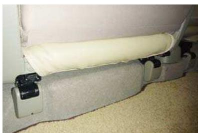
9 8ページの4番で引き出した生地に付いているマジックテープを、シートに直接貼り付けて固定します。
