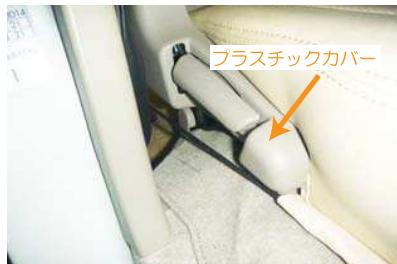
11 外側面のヒモをプラスチックカバーの下を通して背面へ出します。
