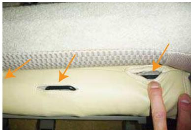
11 チャイルドシート固定用のアンカー3ヵ所とカバーの加工穴3ヵ所の位置が合っていることを確認します。合っていない場合はカバーをなじませ位置を合わせていきます。
