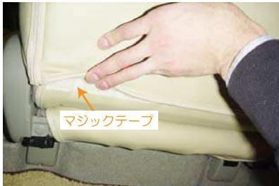
8 10ページの6番で引き出した生地に付いているマジックテープと、カバー背面下に付いているマジックテープを固定します。マジックテープの固定位置は、シートを1番後ろまで倒した時に、生地が座面に干渉しない位置に合わせています。
