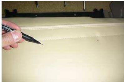
11 16ページの2番で外したグリップの固定穴の位置を指で探し、カバーの上からボールペン等で印を付けます。
