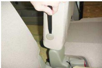
1 助手席側は1列目と同様にシート内側面に付いているアームレストのフタを外し、ソケットレンチ等(12mm)を使用してアームレストを外します。
