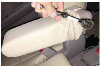
2 内側のみカバーをかぶせ、ソケットレンチ等(12mm)を使用し、アームレストをシートに戻します。
