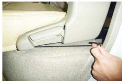
6 側面のヒモをプラスチックカバーの下を通して、背面へ出します。内側面も同様に行います。
