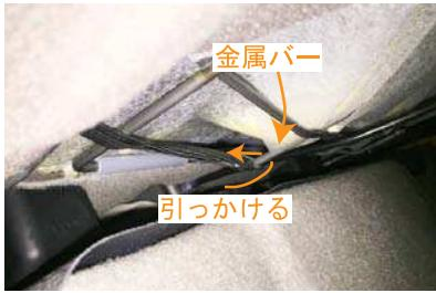
7 座面裏に通したゴムを座面裏にある金属バーに引っかけます。内側も同様に行います。
