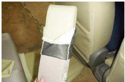
1 カバーを半分程裏返し、アームレストのラインに合わせてかぶせます。アームレストの先端まで生地が張るようにしっかりととかぶせます。
