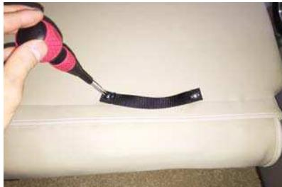
12 11番で付けた印を目安に、予め穴を開けておくか、ネジで生地を突き破り、グリップを元に戻します。
