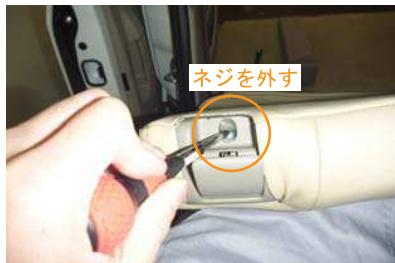
4 シートの肩口に付いている、リクライニンググレバーをドライバー等を使用して外し、カバーの加工穴から取り出します。
