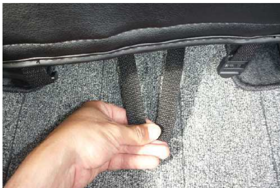
15 シートの背面からベルトを引き出します。
