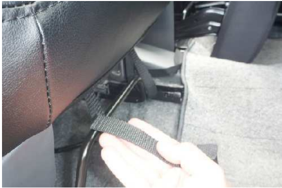
13 カバーの前方に付いているベルトを、シート裏を通して背面から引き出します。
