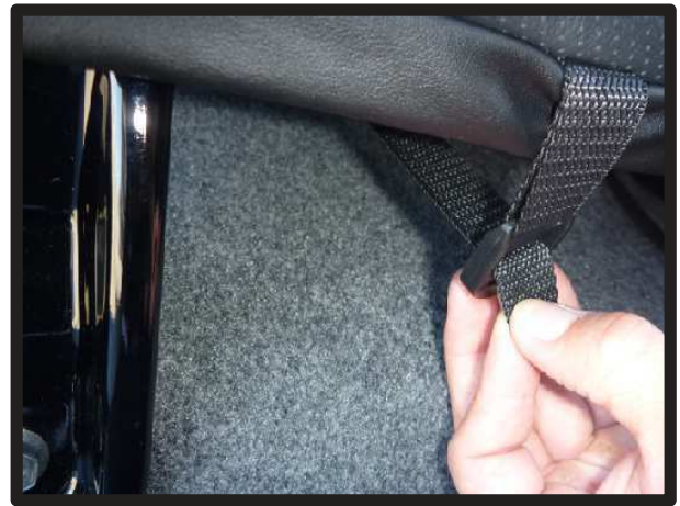
⑦シートの前側から通したベルトを引き出します。カバーの前側に付いているバックルに通して、ベルトを固定します。
