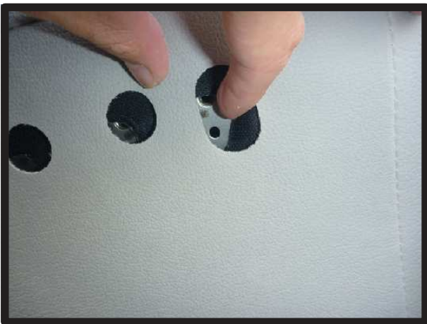
㉓パーソナルテーブル装着車は、テーブルを元に戻します。カバーを装着することで、ボルト穴にシート表皮がずれてかぶさる場合があります。ボルト穴がカバーの加工穴からしっかり見えるように合わせます。
