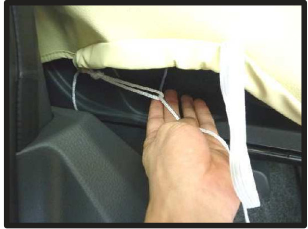
⑦ カバー側面から出ているヒモをシート裏で結び留めます。
