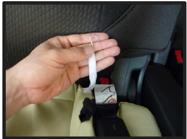
⑨ シートベルトバックル部分です。生地に付いているゴムに、S字フックを取り付けます。シート裏の金属部分に引っ掛けて固定します。
