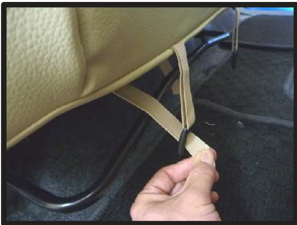
⑥ ④で入れ込んだ生地に付いているベルトをシート裏を通して、シート前側から引き出します。カバー前方に付いているバックルと固定します。
