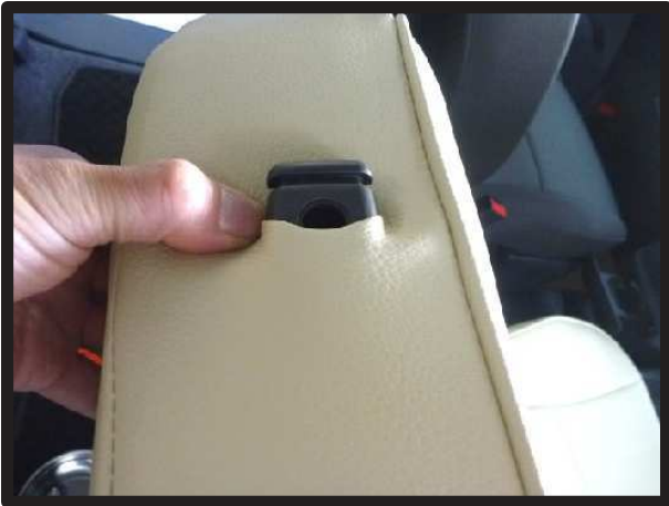
⑩ヘッドレストの台座部分を取り出します。まず台座の片側のフチに、生地をしっかりと入れ込みます。
