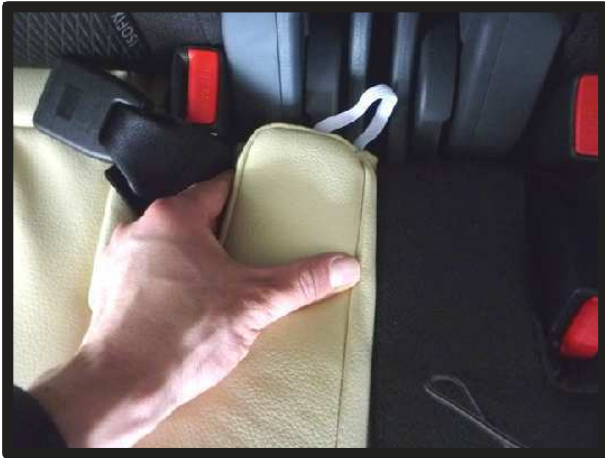
⑤ シートベルトバックルが収納される溝にも生地をしっかりと入れ込みます。
