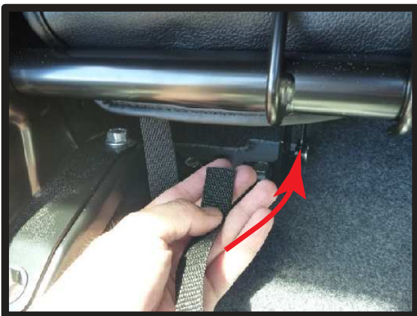
⑥通した生地についているベルトをシート裏を通して、シートの前側に回します。
