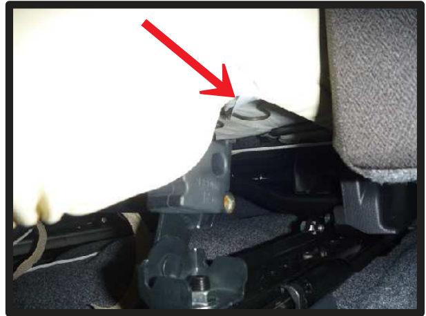
⑧ カバー側面の矢印部分辺りに付いているゴムに、付属のS字フックを取り付けます。S字フックはシート裏の金属部分に引っ掛けて固定します。
