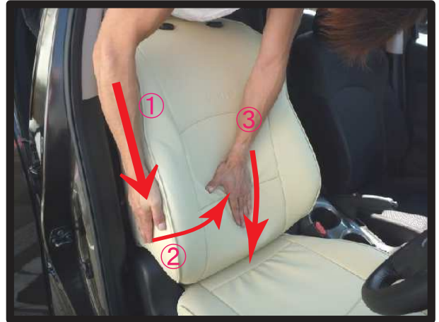
⑭図の①～③の順番に生地をなで下ろしてシートに密着させるようにしわを無くしていきます。 ※別車種の画像を使用しています。
