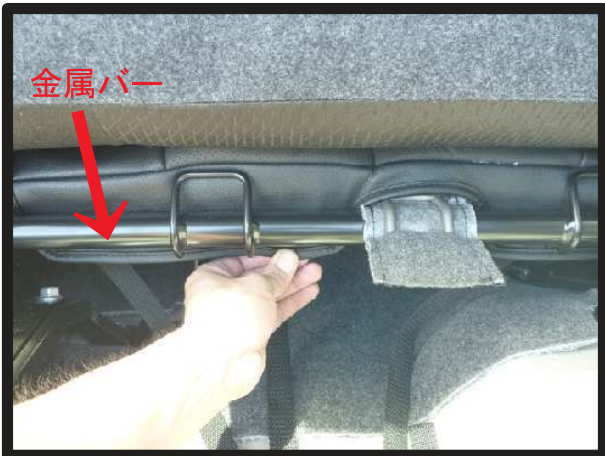
⑤引き出した生地を、図の金属バーの内側に通します。
