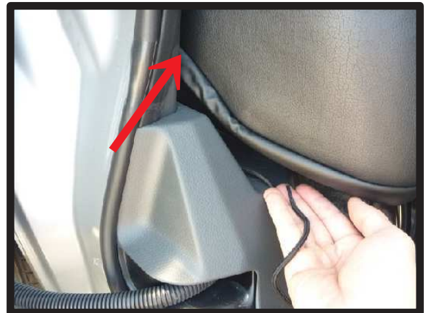
⑧カバー側面の矢印部分辺りに付いているゴムに、付属のS字フックを取り付けます。S字フックはシート裏の金属部分に引っ掛けて固定します。カバー側面から出ているヒモを、シート裏に回します。
