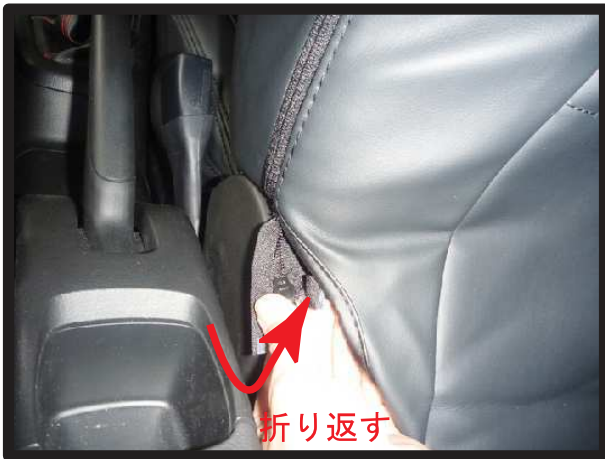
⑧生地からはみ出したファスナー部分は、折り返してカバーの中へ入れ込みます。
