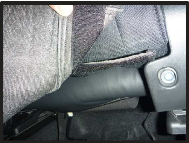
⑨カバー背面下と3ページ⑤で引き出した生地をマジックテープで固定します。
