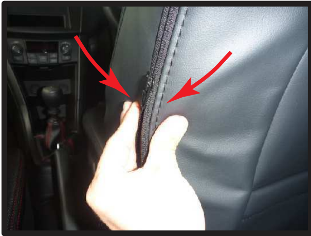
⑦カバー外側面のファスナーを生地を内へ寄せながら、慎重に閉じます。
