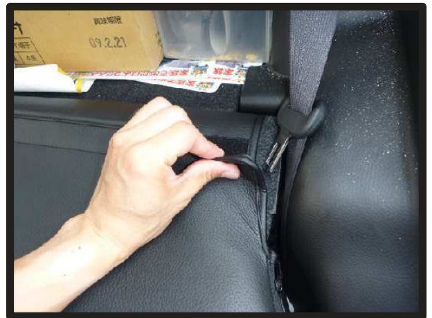
⑱引き出した生地とカバー背面下をマジックテープで固定します。
