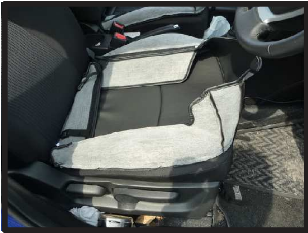
①カバーを裏返して、シートのラインに合わせます。
