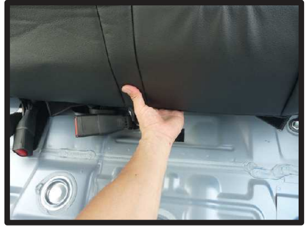
⑭カバー正面下の生地を背面へ入れ込みます。
