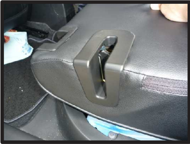
⑬シートを固定する部分は図のように収まります。
