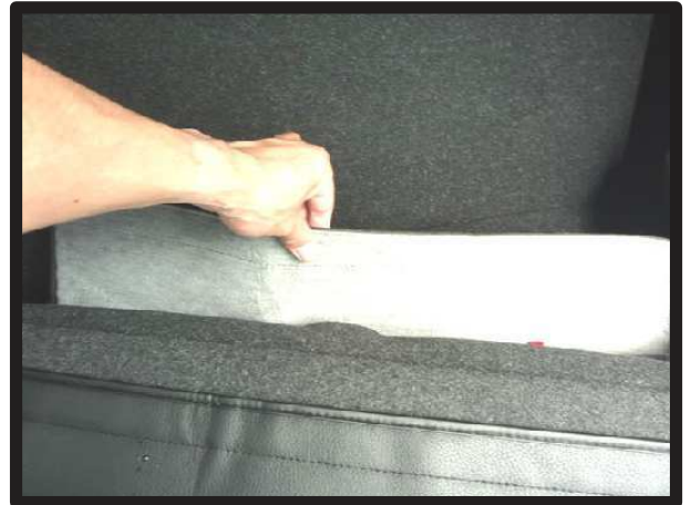
⑯入れ込んだ生地をシート背面から引き出します。 ラゲッジボードを外すと生地を容易に引き出せます。
