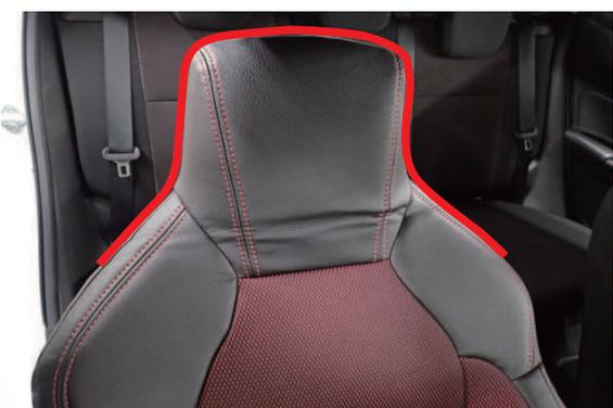
**2** シートのラインに合わせて、カバーをかぶせます。この際、図の赤線部のラインに沿うよう、カバーをシートに馴染ませて下さい。
