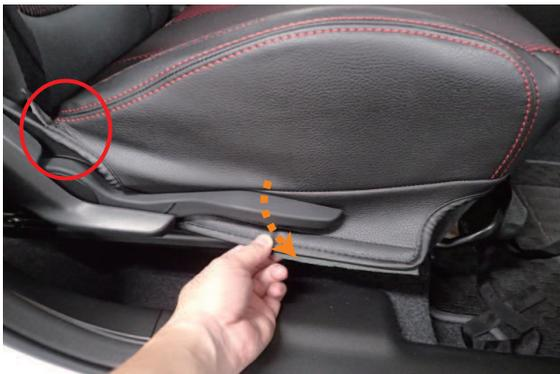
**8** カバー外側面の生地を、シートリフターの下側を通すようにかぶせます。
