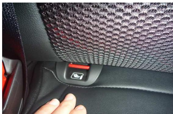
**20** チャイルドシート用アンカーのプラスチックカバーを戻します。取り外した時と逆の手順でアンカー部分にしっかりはめ込んで下さい。
