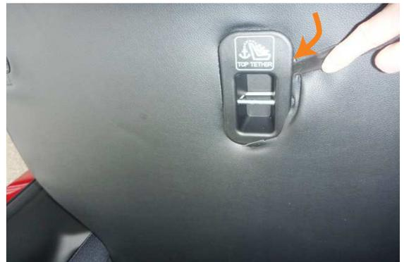
**11** 背面のチャイルドシート用アンカー部の隙間に生地を入れ込みます。
