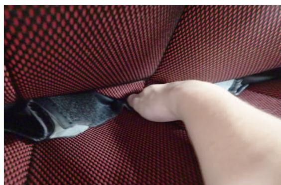
**4** 背もたれと座面の隙間に生地を入れ込みます。背もたれの角度を調整して、入れ込みやすい位置で作業して下さい。
