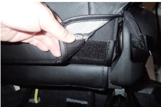
**9** 8番の作業で前側にたるみの出た生地を、もう一度背面から引き出し直し、カバー背面の生地とマジックテープで固定します。
