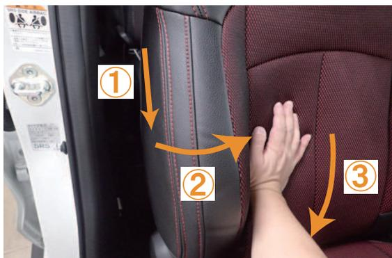
**8** カバー側面の生地を、図の①～③の順番でシートに密着させるようにして、シワを伸ばし、シートに馴染ませます。側面の生地がしっかりと張るまで繰り返し行って下さい。
