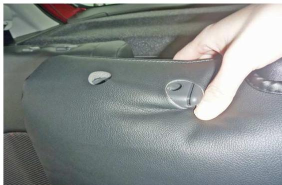
**4** 生地伸びを利用して、カバーの加工穴からヘッドレストの台座を取り出します。
