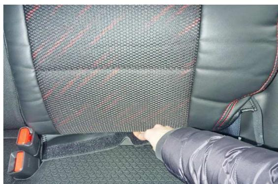
**5** カバー下部の生地を背もたれと座面の隙間に入れ込みます。
