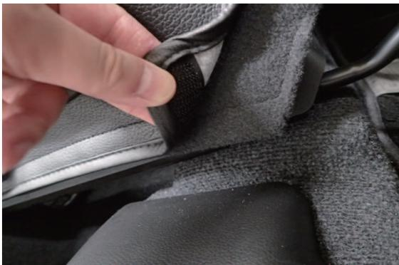
**9** 通した生地が付いているマジックテープをシートに直接貼り付け固定します。
