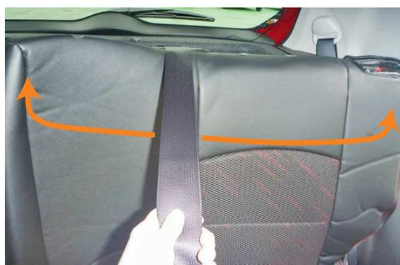
**2** シートベルトをかわしながら、シートのラインに合わせて、カバーを全体にかぶせませす。カバーのヘッドレスト用加工穴をヘッドレスト台座の穴位置に合わせて合わせるようにして下さい。
