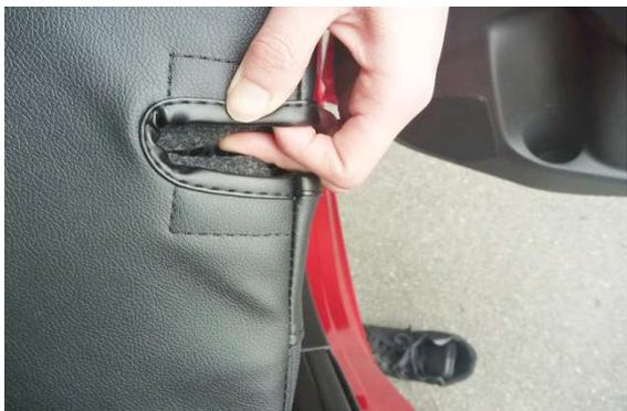
**9** シートの穴位置に、カバー背面の加工穴を合わせ、マジックテープで直接シートに貼り付け固定します。
