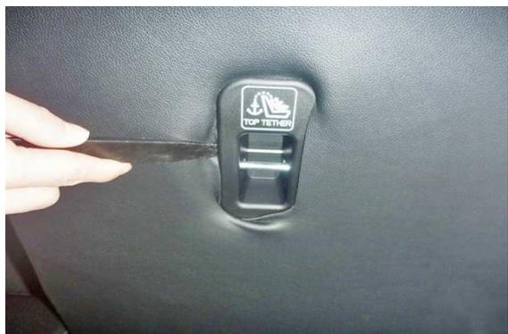
**9** 背面のチャイルドシート用アンカー部の隙間に生地を入れ込みます。
