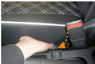
14 カバー内側面後ろ側の生地の端に、マジックテープが2本付いています。そのマジックテープをシートの隙間に通して、シート裏へ入れ込みます。
