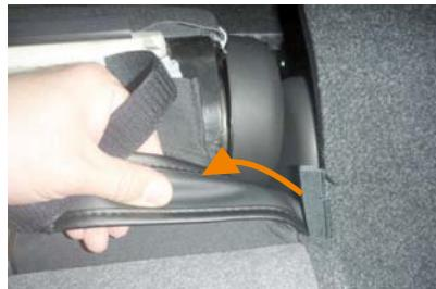
10 シート表皮をめくり上げ、シート背面からカバー側面下のマジックテープが付いた生地を引き出します。
