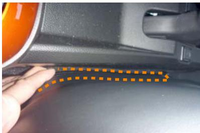
7 カバー内側面前側の生地裏に付いているマジックテープを、シートに直接貼り付けて固定します。
