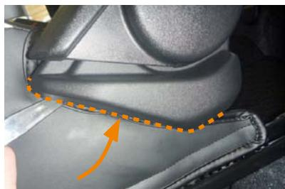
3 シート外側のプラスチック部の隙間に生地を下から上へ入れ込みます。
