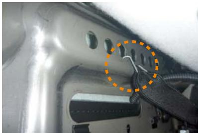
9 金属フックをシート裏の側面部分に引っ掛けで固定します。
