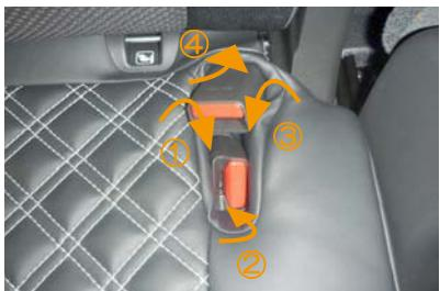
14 シートベルトバックル収納部にカバーの穴位置を合わせて、フチに生地を入れ込みます。図の①②③の部分はフチに沿って生地を入れ込みます。④の部分は下へ入れ込むのではなく、生地を奥へ押し込むように入れ込みます。
