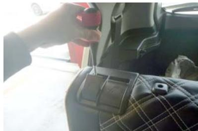
4 1番で外したレバーのプラスチックカバーを、生地を挟み込み元に戻します。
