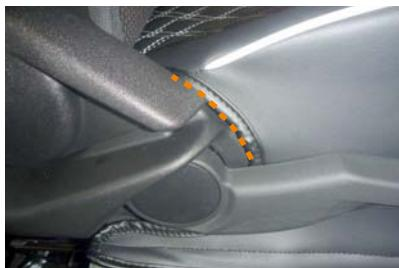
7 カバーのラインを確認します。外側面の生地がシートのプラスチック部分に沿うようになっていることを確認します。すれてい る場合はカバーの装着位置を調整して下さ い。
