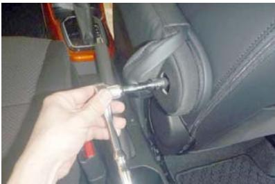
3 アームレストをシートに戻します。側面のキャップを戻し忘れないようにご注意下さい。
