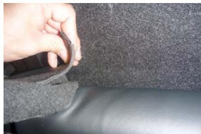
4 引き出した生地を軸部分をかわしてシートに直接貼り付けて固定します。
