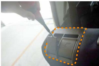
1 カバーを装着する前にシート肩口にあるレバー部分を外します。レバーを上げて中のネジをドライバーを使用して外すと、レバーのプラスチックカバーごと、シートから外れます。※ワイヤーがつながっているので完全には外れません。
