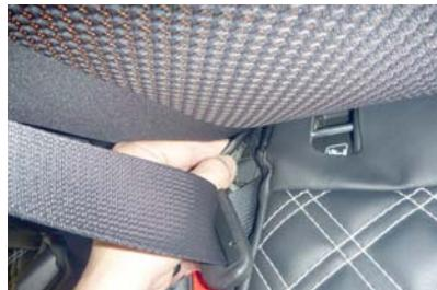
16 助手席側は中央シートベルトを交わしてカバーの装着を行います。ベルトの奥側でカバー同士をマジックテープで固定します。
