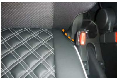
8 カバー内側の生地が、軸の部分に沿うよう なっていることを確認します。すれてい る場合はカバーの装着位置を調整して下さ い。
