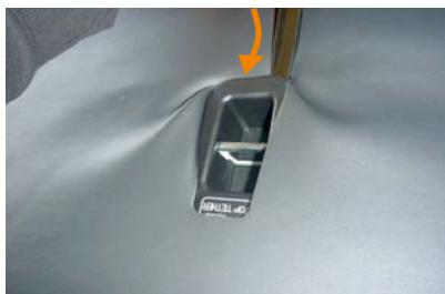
15 シート背面のチャイルドシート固定用フック部分を加工穴から取り出します。プラスチックカバーのフチに、ヘラなどを使用して生地を入れ込みます。
