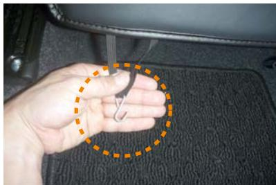
10 カバー背面下に付いているゴムに、付属の金属フックを取り付けます。
