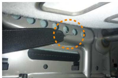
5 金属フックをシート裏の側面部分に引っ掛けで固定します。
