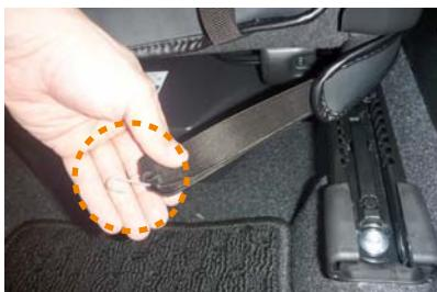
8 カバー内側面後ろ側の生地の端に、ゴムが付いています。ゴムに付属の金属フックを取り付けます。
