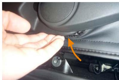
11 シート外側面下のプラスチック部の隙間に 生地を下から上へ入れ込みます。
