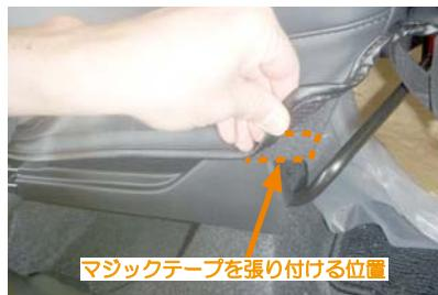
10 カバー外側面下の生地裏に付いているマジックテープを、シートに直接貼り付けて固定します。
