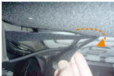
16 シートの裏側から引き出したマジックテープを、シート裏の金属部分に巻き付けて折り返し、マジックテープ同士を固定します。
