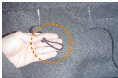
10 シートの背面から両方のヒモを引き出して片側のヒモで輪を作ります。
