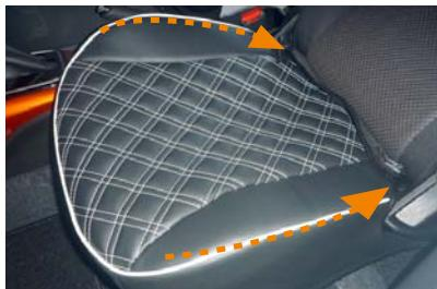
1 シートのラインに合わせてカバーを前から後ろへ、シート全体にかぶせます。背もたれと座面の隙間に生地を入れ込みます。
