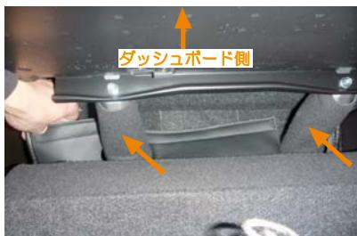
3 入れ込んだ生地をシート背面から引き出します。シート背面には図の矢印部分に軸があるので、軸部分をかわして生地を引き出します。
