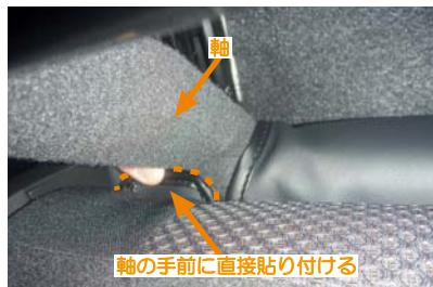
17 背もたれと座面の隙間に入れ込む生地の内側は、助手席側は短くなっています。短い部分の生地は、軸の手前でシートに直接貼り付けて固定します。
