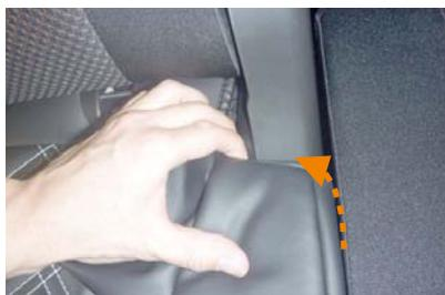
8 カバー両側面のシート軸部分の生地を、シートの内側に引っ掛けるように入れ込みます。
