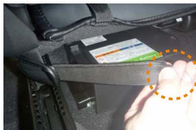
4 カバー外側面後ろ側の生地の端に、ゴムが付いています。ゴムに付属の金属フックを取り付けます。
