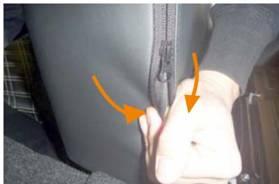
13 カバー側面のファスナーを内へ寄せながら慎重に閉じます。ファスナーの端はカバーの中へ入れ込みます。
