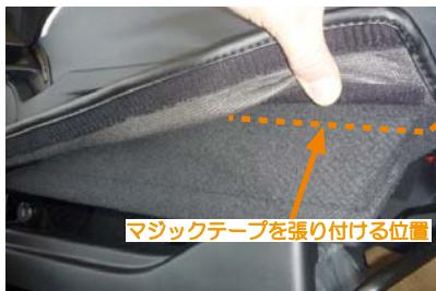
9 カバー外側面の生地裏に付いているマジッ クテープを、シートに直接貼り付けて固定 します。マジックテープに保護テープが付 いている場合は、固定する前に外して下さ い。
