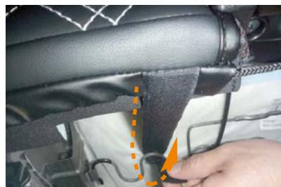
12 カバー前側のスライドレバー部の両端に付いているマジックテープを、シート裏の金属部分に巻き付けて固定します。マジックテープの固定方法はアベージ16番17番を参照下さい。
