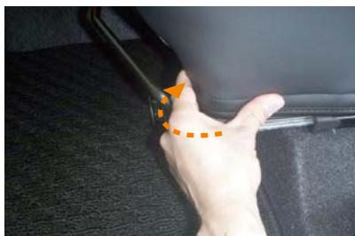
2 カバー側面の前側をシートに巻き付けるように、マジックテープで直接貼り付けて固定します。そのままシートの背面側まで固定していきます。運転席のカバーはマジックテープが外側に上下に2か所付いていましたが、助手席側は下側1か所です。
