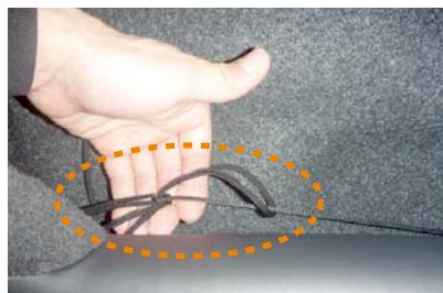
11 もう片側のヒモを、作った輪に通します。通したヒモを引き、座面下回りを絞り込み緩まないように結び留めます。
