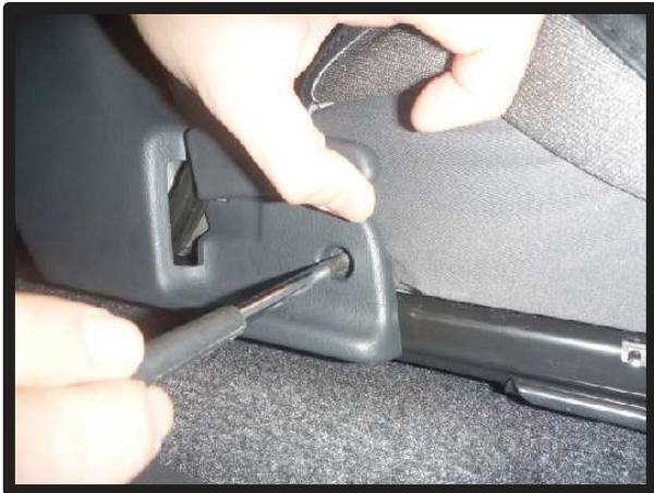
⑧リクライニングレバー下にあるネジを外します。 ※取り外したネジは無くさないように注意して下さい。
