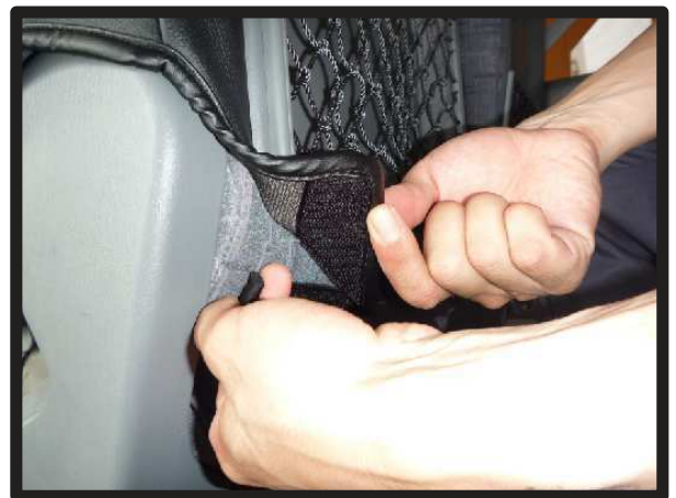
⑨⑦で引き出した生地とカバー背面下 をマジックテープで固定します。
