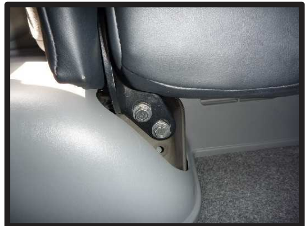
⑪ 7 ページの①で外したステーを元に戻します。
