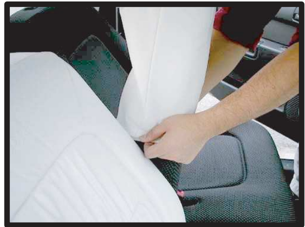
⑤アームレストカバーをかぶせます。マジックテープ部分を折り返して本体になじませるようにかぶせていきます。
