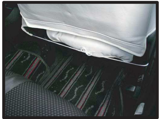
④座面後ろ側に紐を取り出し、固定します。片側の紐で輪を作り、反対側の紐を通して絞り込んでから結びます。
