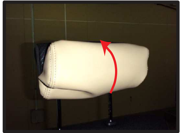
① カバーの前後を確認します。 平らなプラスチックの部品が付いているほうが前です。 前側からもぐり込ますようにかぶせます。
