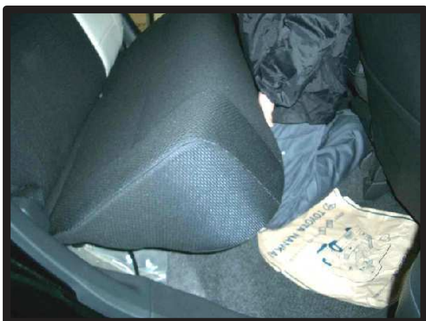
②座面の前側を持ち上げ車体から座面を取り外します。 シートを車体から下ろす際、車体に傷を付けないよう注意して下さい。
