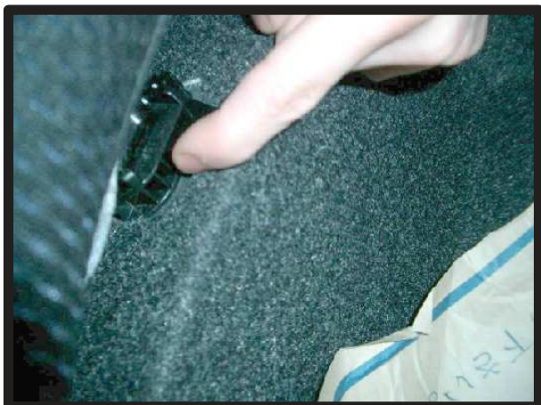
①座面前下側にあるロックのフックを外します。（2ヶ所）
