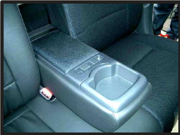
⑦ボックスのネジを締め固定し、カバーのラインを整えて1列目アームレスト（本体）の完成です。
