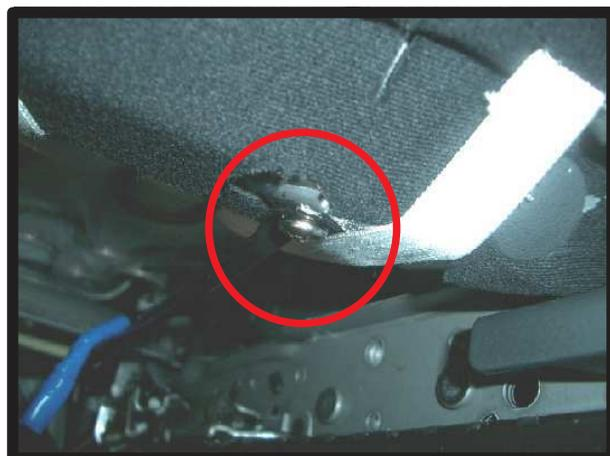
①シートアンダートレイを固定しているネジを外します。ネジの場所は座面裏側後方に2ヵ所あります。
