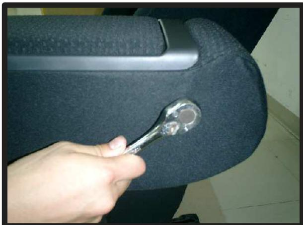
①アームレストを取り外します。キャップを外して、内にあるボルトをソケットレンチで外します。
