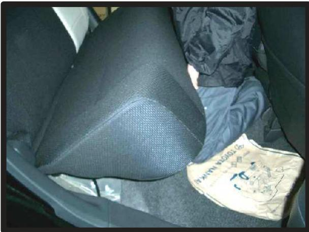
②座面の前側を持ち上げ車体から座面を取り外します。
