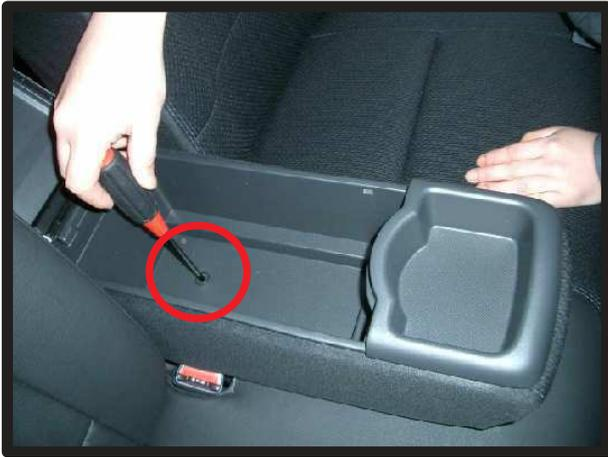
① 1列目背もたれのカバー取り付け時に外したアームレストを戻します。アームレストのボックスを取り外します。フタを開け、ドライバーを使用してネジを取り外します。
