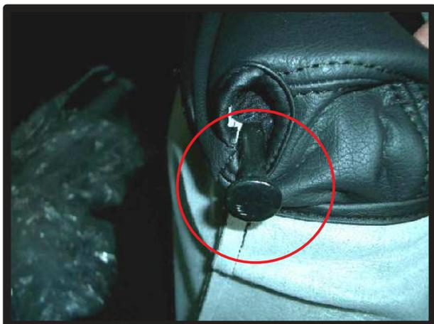
① 2列目背もたれは、背もたれを固定している金具が肩口の片側に付いているので、その部分を避けてカバーをかぶせます。金具部にカバーを引っ掛けると生地が破れる恐れがあります。
