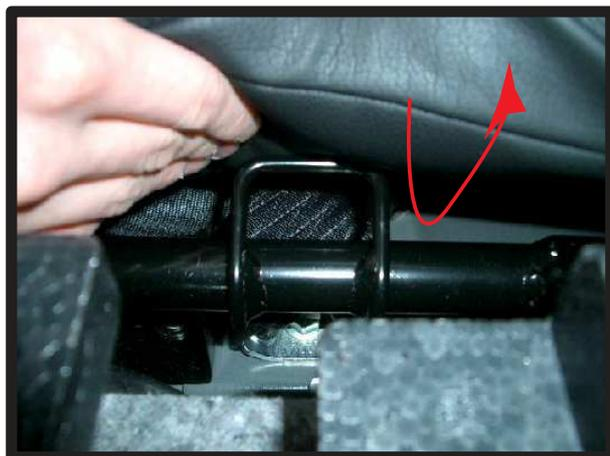
④ 入れ込んだカバー部分は、座面を固定している鉄製アームの上を通して後ろ側に引き出します。
