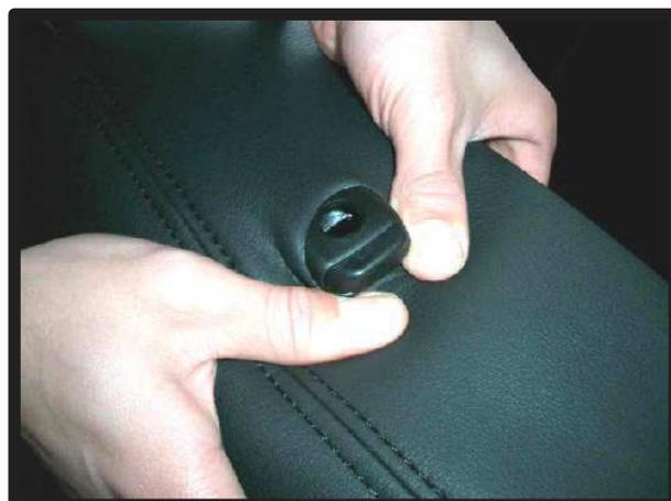
⑤ヘッドレストの台座部分を穴から取り出します。生地伸びを利用して横からもぐり込ますように取り出して下さい。無理に入れると破れる恐れがありますので御注意下さい。
