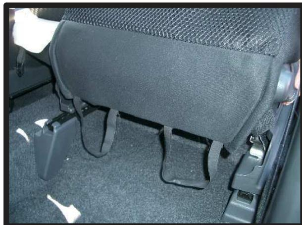
④座面裏側に付いているカバーを外します。座面の下にゴムで固定されているので、前に押すようにして外して下さい。
