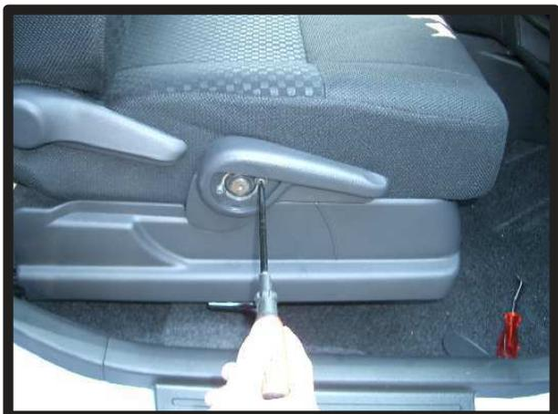
①シートリフターのレバーを取り外します。キャップを取り、ネジで2箇所固定してあるので、ドライバーを使用して外します。
