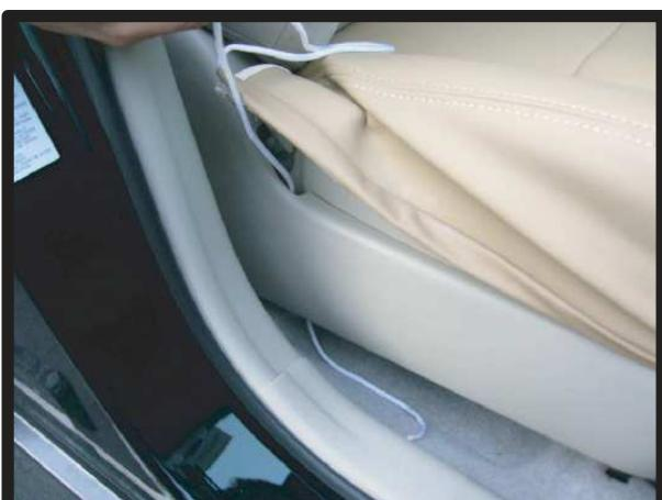
③両サイドにヒモが有る場合は、ヒモをシート本体とプラスチックカバーの隙間に入れて、下から抜き取るようにして背後に回しておきます。
