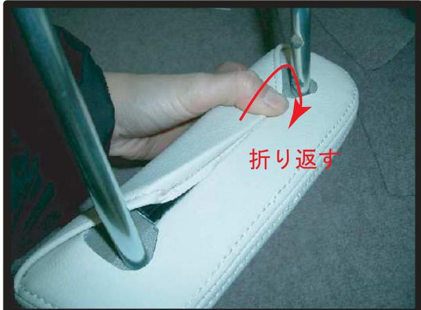
④平らなプラスチックの付いた部分を内側へ巻き込むように折り返して、フック状のプラスチックの溝に押し込んでいきます。
