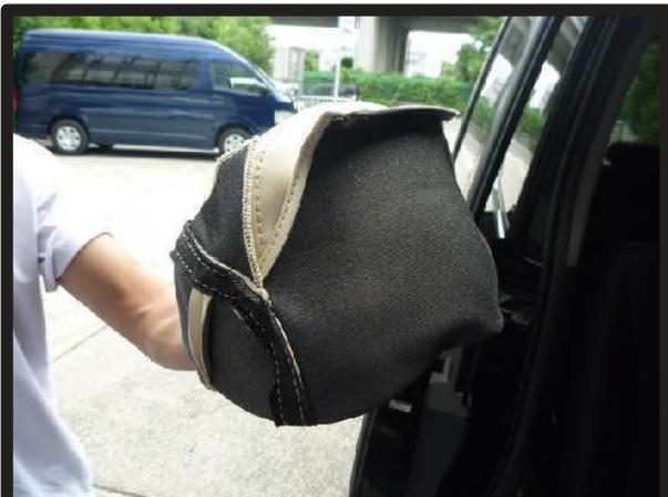
①ヘッドレストにカバーを装着する際は、写真のようにカバーを裏返した状態でかぶせます。
