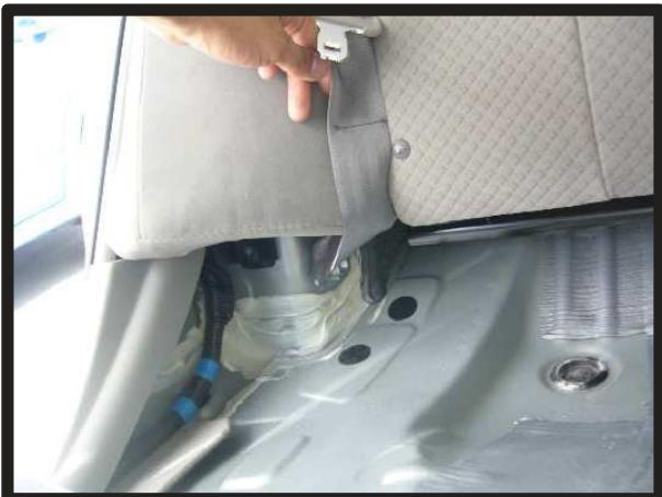
①座面を取り外した状態や、跳ね上げた状態のときに、ネジやナットが現れますので、取り外します。
