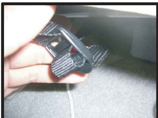
⑥ベルトが付いている場合は、前後のベルトを座面下部で固定します。
