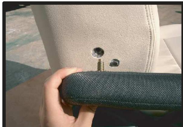
④肘掛けを取り付けます。この時、肘掛けや背もたれの形状をよく確認してから、ボルト等を締めてください。形状や位置が合わないまま強引に取り付けるとシート本体やボルト等を破損させてしまう恐れがあります。
