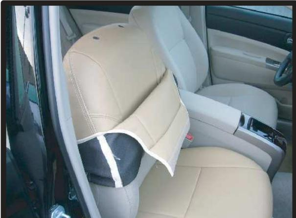
①ヘッドレストを外し、背もたれカバーをかぶせます。シートカバーにアームレスト用の穴加工がされていない場合は、次項をご参照下さい。
