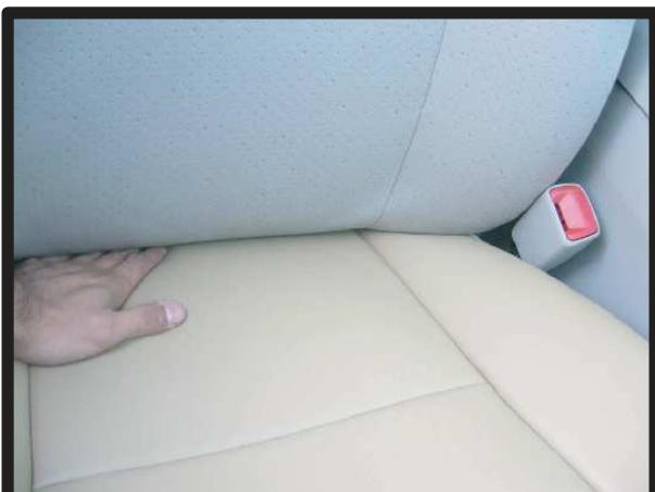
②カバーを座面と背もたれの隙間に入れ込んで、背面から抜き出します。
