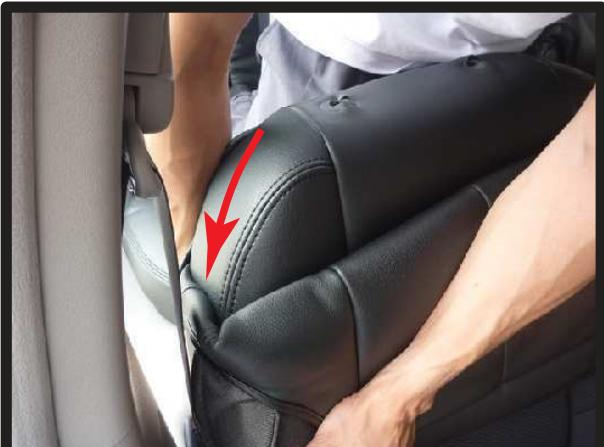
①背もたれカバーを半分裏返した状態でシートにかぶせます。写真のように肩口をしっかりと入れ込み、シートとカバーのラインを合わせます。
