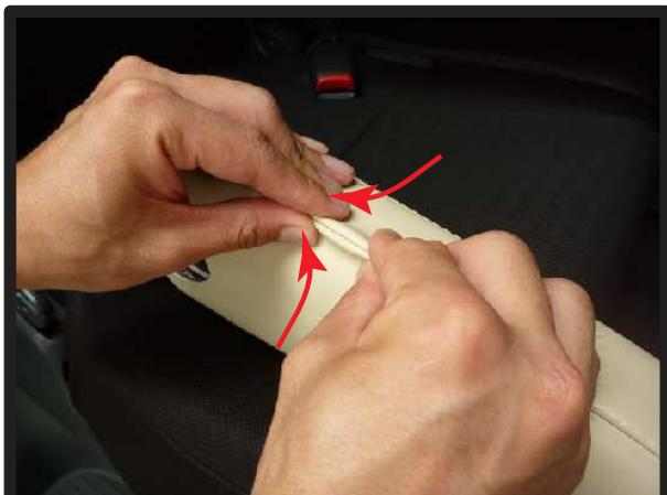
⑤④の状態を治す為に、写真のように表面が整っていない生地をつまみ、一定方向に縫い代が向くように調整します。
