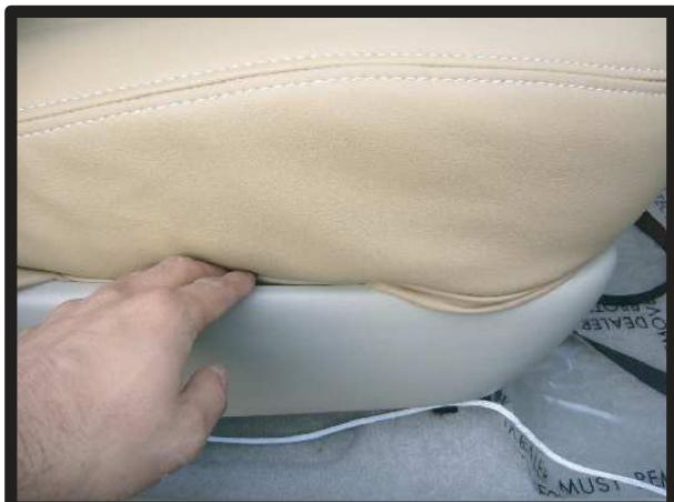
④シート本体の形状によりますが、プラスチックカバーが有る場合は、カバーの隙間に生地を挟み込みます。
