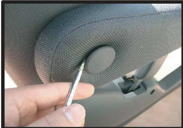
①肘掛け取付金具のプラスチックカバーを外します。マイナスドライバーもしくは内張りはがしを使い手前に押し上げるようにしてはずします。ファスナーが付いているタイプの肘掛けは生地をめくり、ファスナーを開けます。
