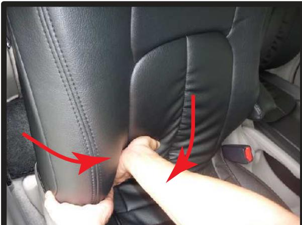
⑥⑤の状態を維持しながら、前面の生地を、背もたれと座面の隙間にに入れ込みます。
