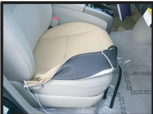
①座面の表面のラインに合わせて、カバーを被せていきます。
