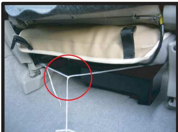
⑤手順③で抜き出しておいたヒモを、片側のヒモで輪を作り、もう一方のヒモを輪に通して、適度な力で引っ張り、結んで固定します。
