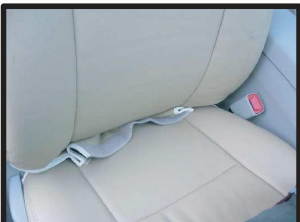
②マジックテープ部分を、座面と背もたれの隙間に入れ込んで、背面に抜き出しておきます。
