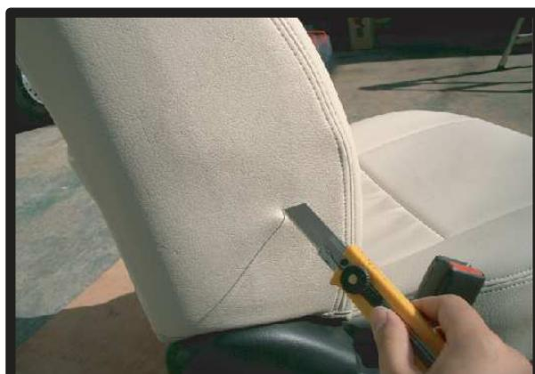
③背もたれカバーを正確な位置に取り付けた後、ボルトが入る位置に穴を開けます。背もたれから出ている支持棒も穴を開けて取り出してください。
