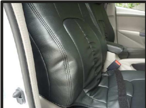
④カバーを引き下げただけの状態ですと写真のように、シートの張り出し感が出なかつたり、側面にシワが出てしまします。
