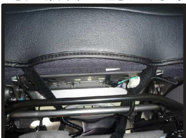
⑥ベルトは、カバーの浮きを防ぐ為の補助的なものですので、必要以上に締め過ぎると、乗り降りを繰り返すうちにカバーとベルトが引張られて切れる恐れがあります。
