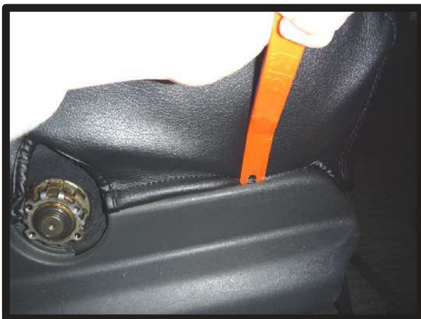
⑨側面の生地をプラスチックカバーの中に入れ込みます。
