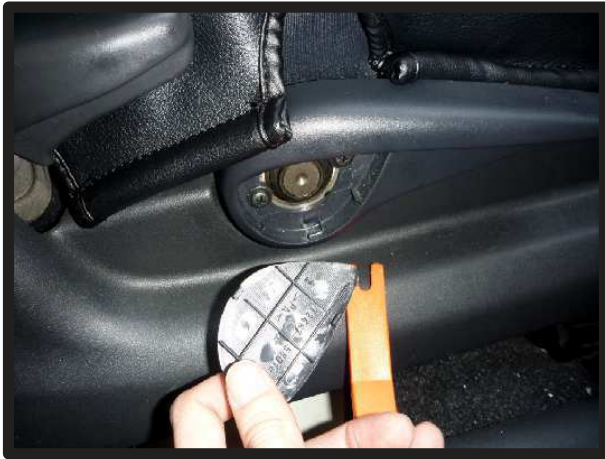
⑦シートリフターを外します。 プラスチックカバーをヘラ等を使用して外します。
