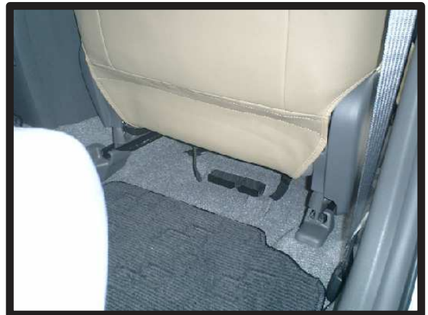
⑪S字フックは座面裏の金属部分に引っ掛け固定します。背もたれの背面下は写真のように収まります。
