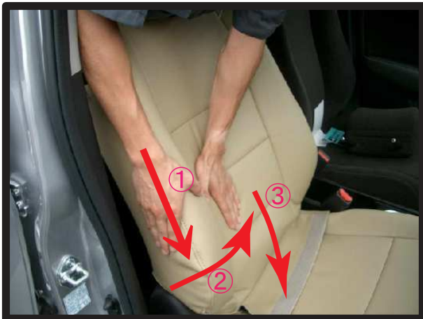
⑧①～③の順番にカバーをなで下ろして、シートに密着させるようにシワをなくしていきます。
