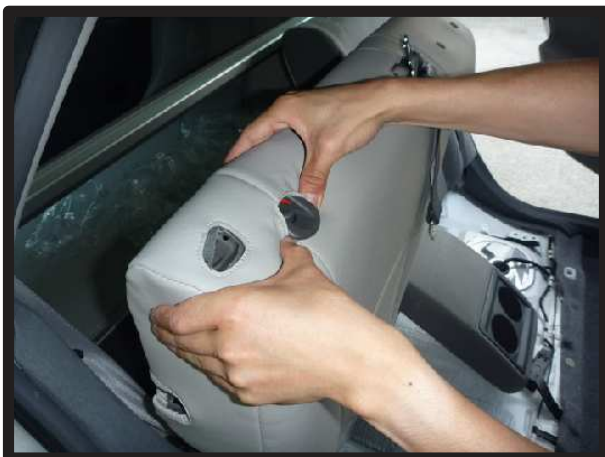
⑫リクライニングボタンをカバーの加工穴から取り出します。
