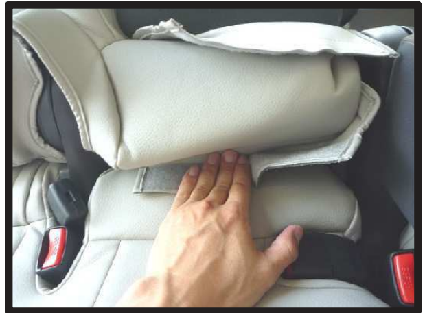
④アームレスト下の生地も背もたれと座面の隙間に生地を入れ込みます。
