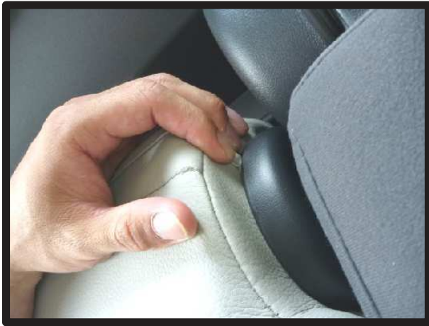
⑦シート背面です。シート付け根部分に生地を入れ込み
