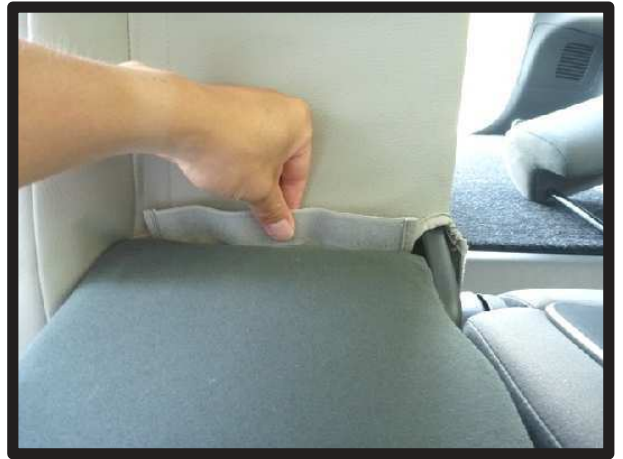
⑭入れ込んだ生地をアームレストを倒して引き出します。
