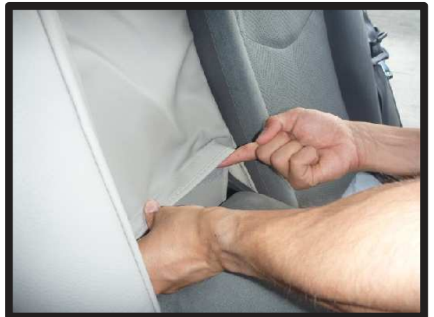
⑯引き出した生地とアームレスト収納部の下の生地を、マジックテープで固定します。
