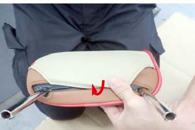
3 ヘッドレストをシートから外して、ヘッドレストの裏側でプラフックを固定します
