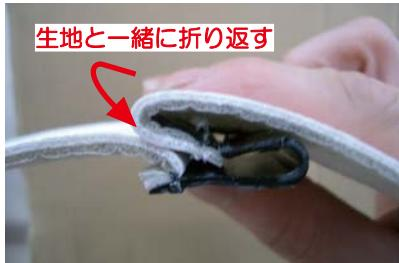
4 プラフックの固定方法は、かぎ状のフックに平らな方のプラスチックを生地と一緒に折り返して、はめ込み固定します。
