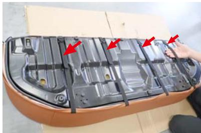
5 シートを裏返して前後のベルト4本を固定します。ベルトの固定方法はアページ13番を参考にして下さい。
