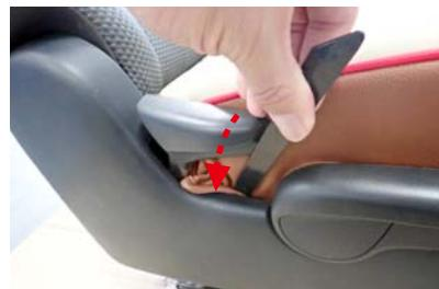
6 運転席はシートリフター部分をかわして、リクライニングレバーの内側の生地もシートとプラスチックパーツの隙間に入れ込みます。
