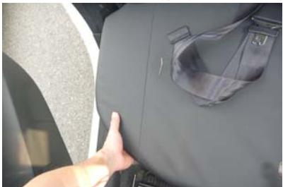
1 2列目座面はシートを車体から外してカバーの装着を行います。シートはシート裏のフックで固定されています。フックの位置を確認して、シートを真上に持ち上げることで外れます。フックの固定はかなり固くなっています。腰などに負担が掛からないようにご注意下さい。
