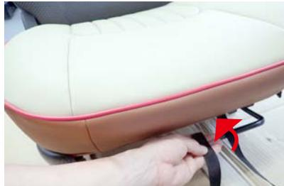
10 カバーの前側に付いている2本のベルトをシートの裏から背面へ通します。この際ベルトはスライドレバーの上側を通すようにして下さい。
