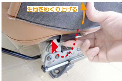
8 カバー内側の生地を一枚めくり上げると、内側にフックが付いています。フックをシートのフチに引っ掛けで固定します。
