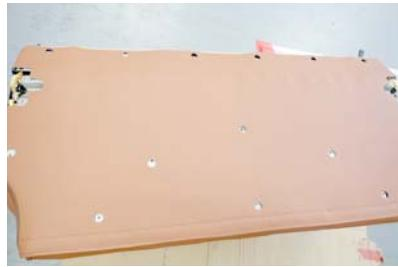
16 シート背面の加工穴とリベットピンが留まる穴位置がずれていないか確認します。加工穴から穴位置がずれている場合は、カバーを調整して穴位置を合わせるようにして下さい。
