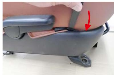
5 カバー外側面の生地をシートとプラスチックパーツの隙間に入れ込みます。
