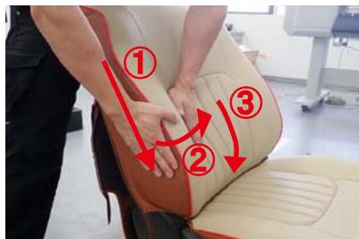
6 カバーを①→②→③の手順でシートに馴染ませていきます。③で引き下ろした余った生地は、5番の作業と同様にシート背面から引き出します。
