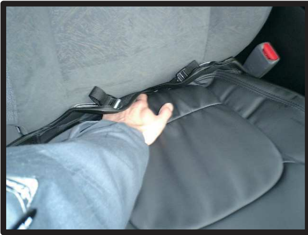
⑦ベルトのバックル部分のカバーを、背もたれと座面の隙間に入れ込んでいきます。
