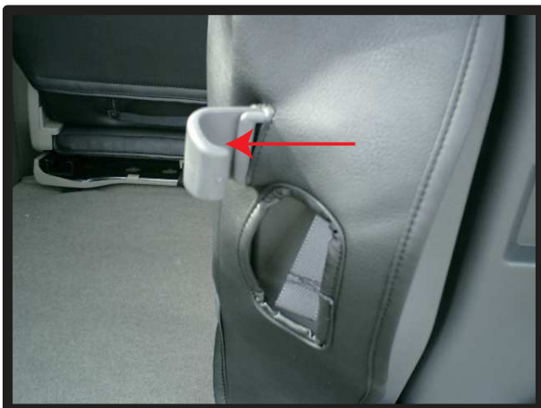
③シートを跳ね上げ、カバーの切れ目のある箇所から、跳ね上げ固定用フックを抜き出します。
