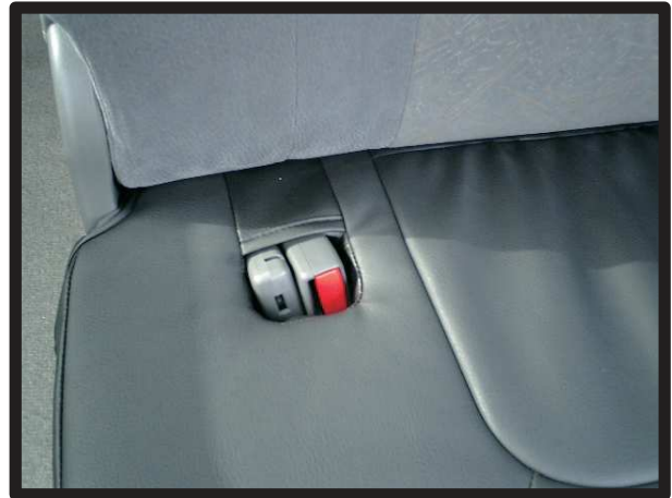
④表面を整えて、シートベルトの受け口を穴から抜き出します。
