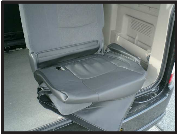
①シートのラインに合わせて、カバーをかぶせていきます。
