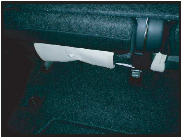
⑪座面後方にあるゴムと側面のゴムを座面下に固定します。
