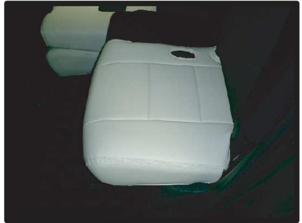
⑬座面全体を整えて完成です。 2列目運転席側の座面も助手席側座面とほぼ同様に取り付けますが、側面のベルトとゴムは付いておりません。
